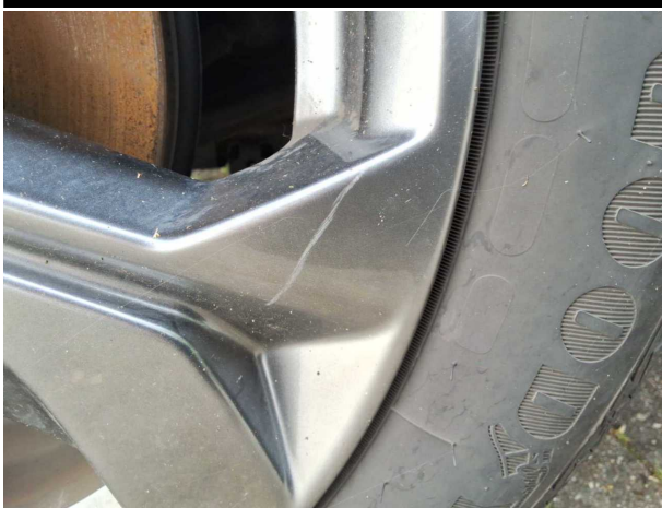
Beschädigung #2: Rad/Reifen: Leichtmetallfelge vorn links - Kratzer - Smart Repair
