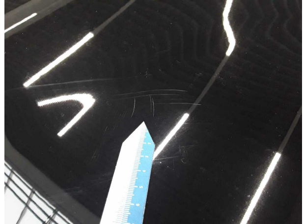
Beschädigung #1: Motorhaube: Motorhaube - Kratzer - lackieren
