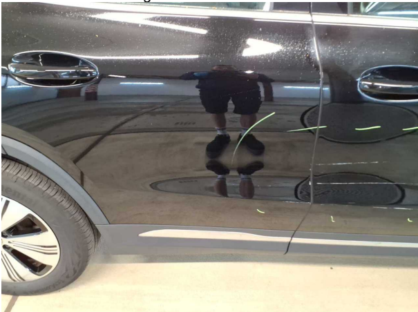
Beschädigung #3: Tür hinten rechts: Tür - verkratzt / verschürft - instandsetzen und lackieren
