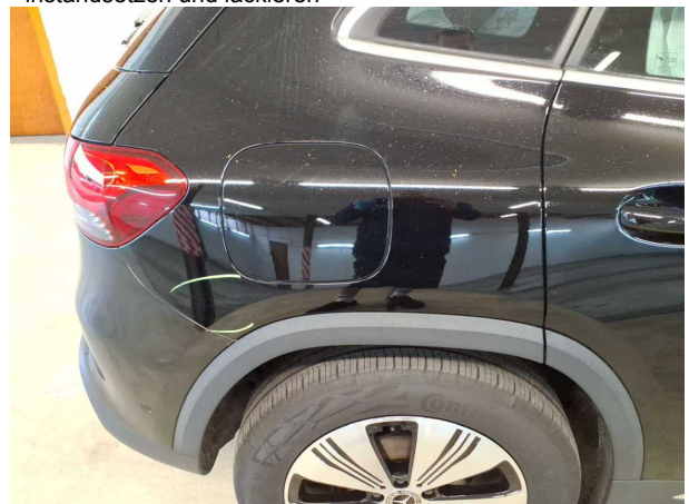
Beschädigung #4: Seitenwand rechts: Seitenwand - verkratzt / verschürft - instandsetzen und lackieren
