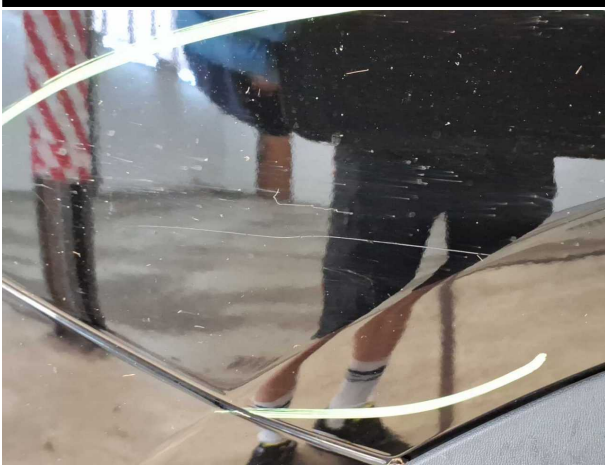
Beschädigung #4: Seitenwand rechts: Seitenwand - verkratzt / verschürft - instandsetzen und lackieren
