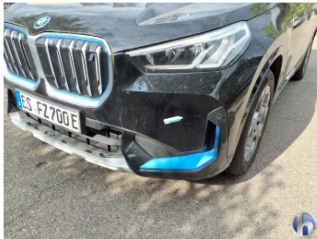
1. Stoßfänger Vorne Kratzer - Smart Repair
