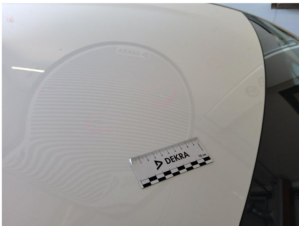
Bild 24 : Dach, mehrfach eingedellt, drücken 50 Dellen
