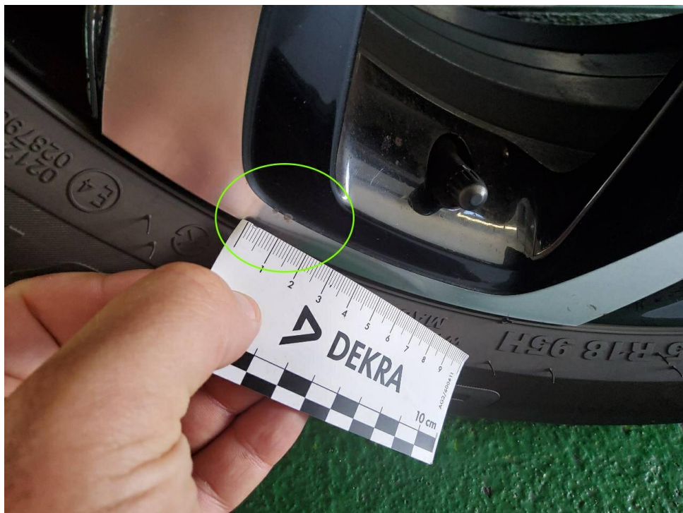
Bild 32 : Felge vorn links, leichte Korrosion
