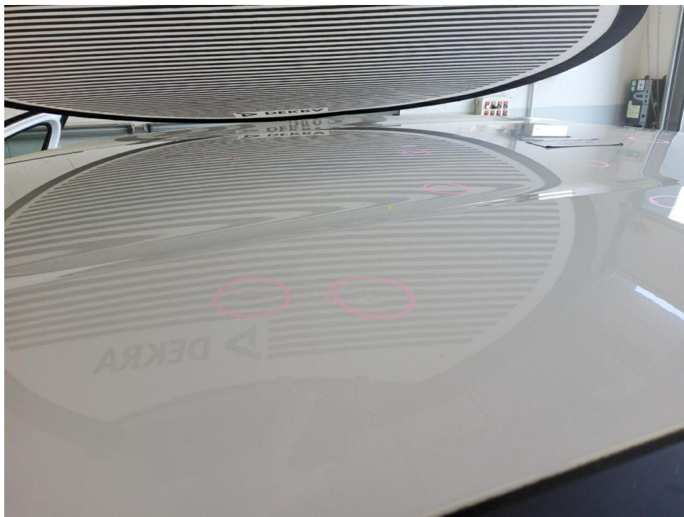
Bild 17 : Dach, mehrfach eingedellt, drücken 50 Dellen
