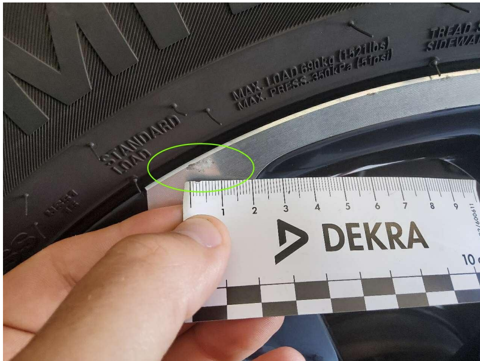
Bild 31 : Felge hinten links, leichte Korrosion
