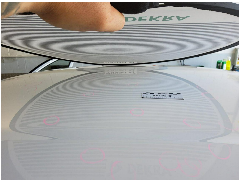
Bild 19 : Dach, mehrfach eingedellt, drücken 50 Dellen
