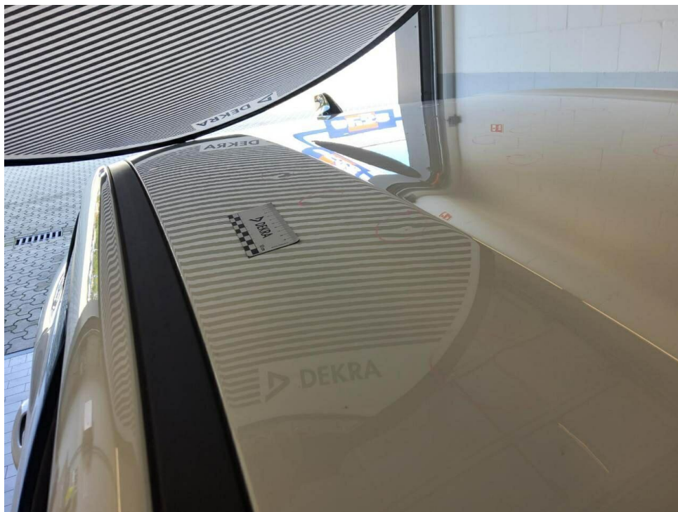
Bild 23 : Dach, mehrfach eingedellt, drücken 50 Dellen
