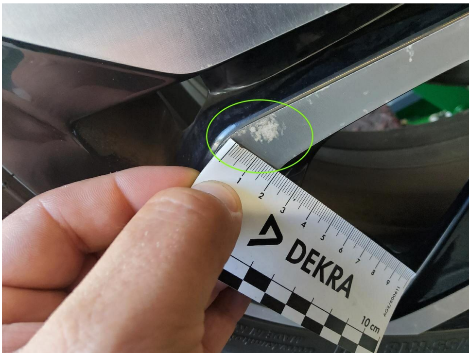
Bild 30 : Felge hinten rechts, leichte Korrosion
