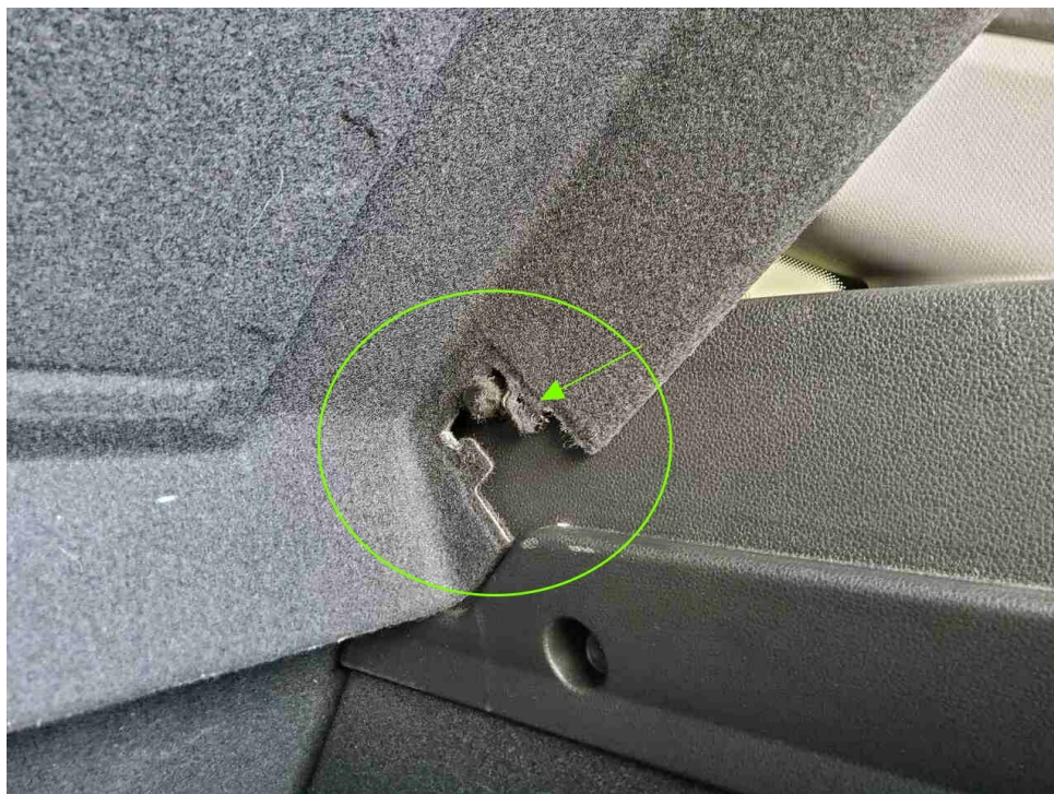
Bild 16 : Hutablage, Aufnahme rechts gebrochen und nicht vollständig
