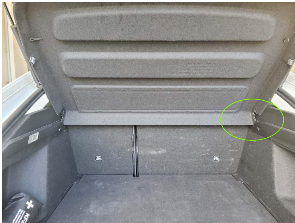
Bild 15 : Hutablage, Aufnahme rechts gebrochen und nicht vollständig
