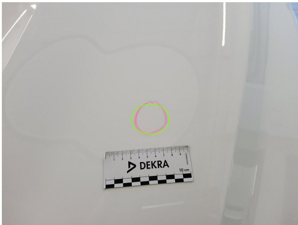
Bild 26 : Motorhaube, eingedellt, Gebrauchsspur
