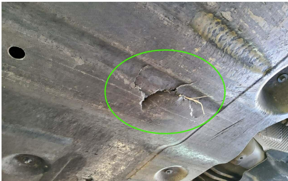
Bild 42 : Unterbodenverkleidung Motor gebrochen erneuern
