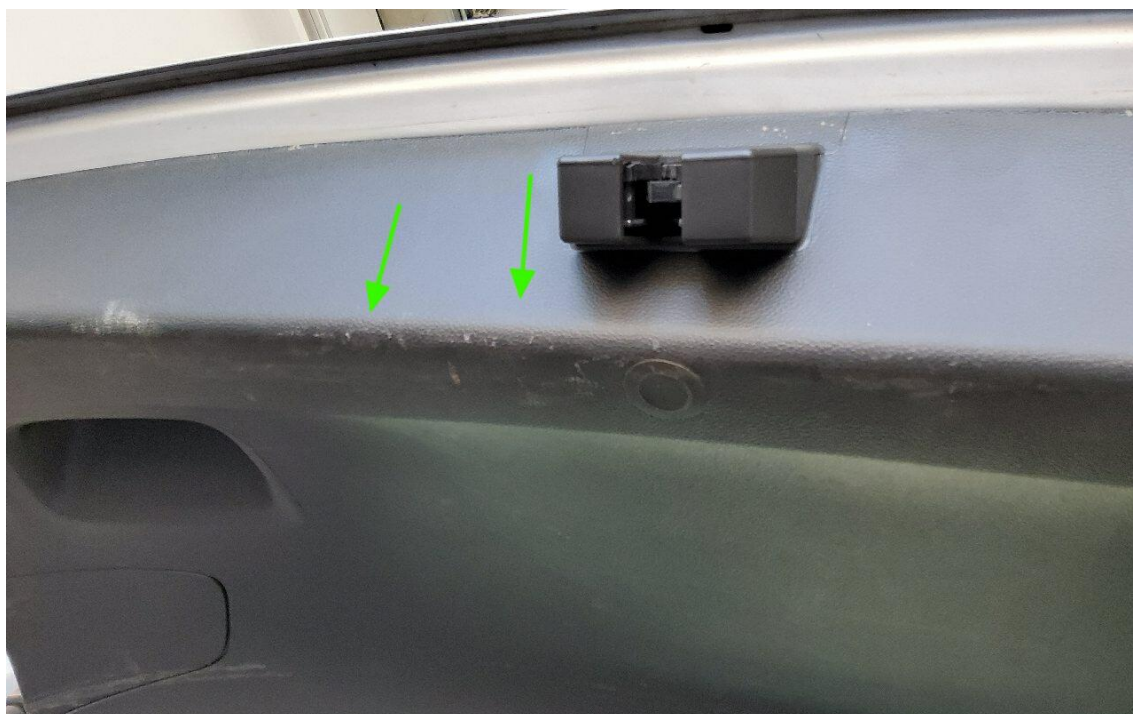
Bild 28 : Verkleidung Heckklappe verschürft erneuern
