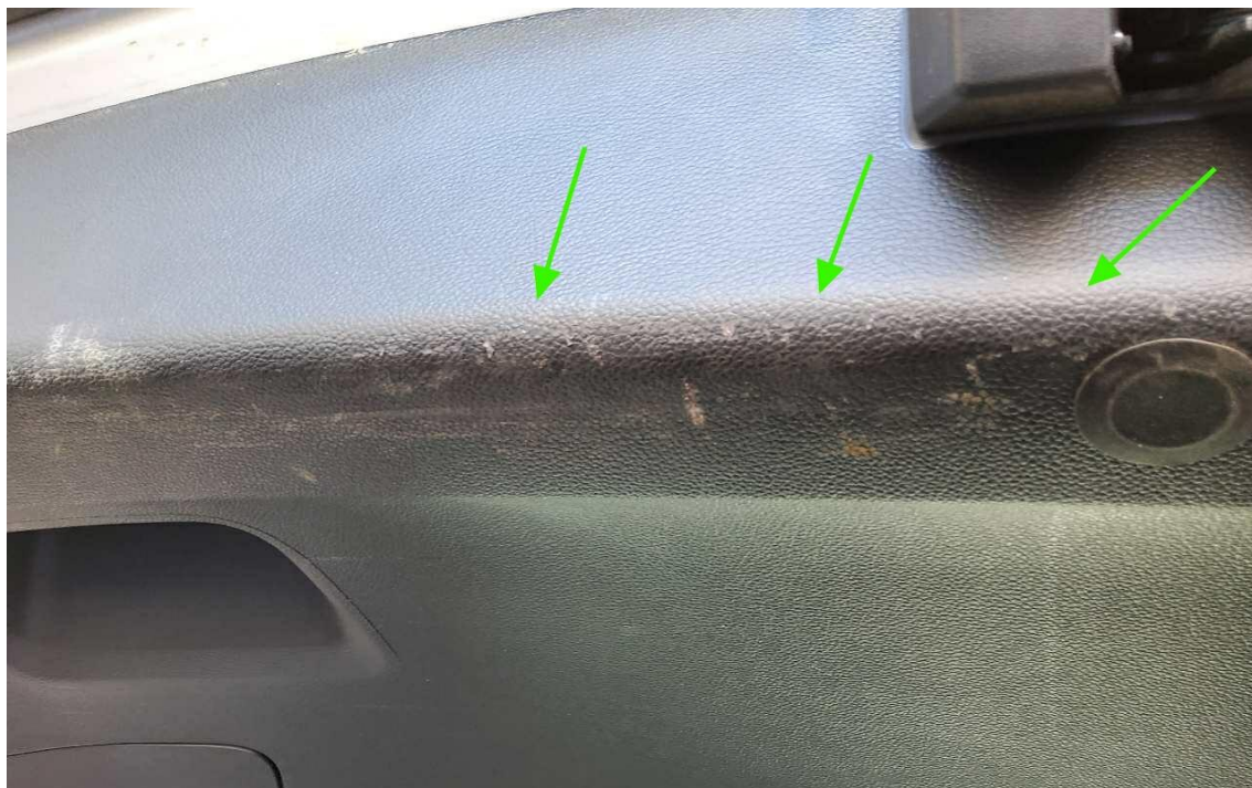
Bild 29 : Verkleidung Heckklappe verschürft erneuern
