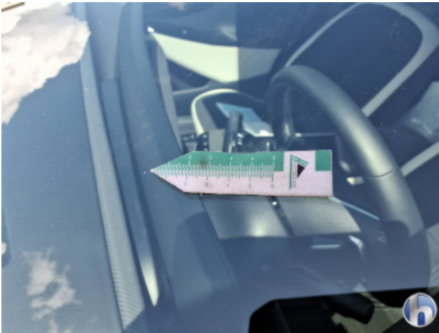
3. Windschutzscheibe Steinschlag - Smart Repair
