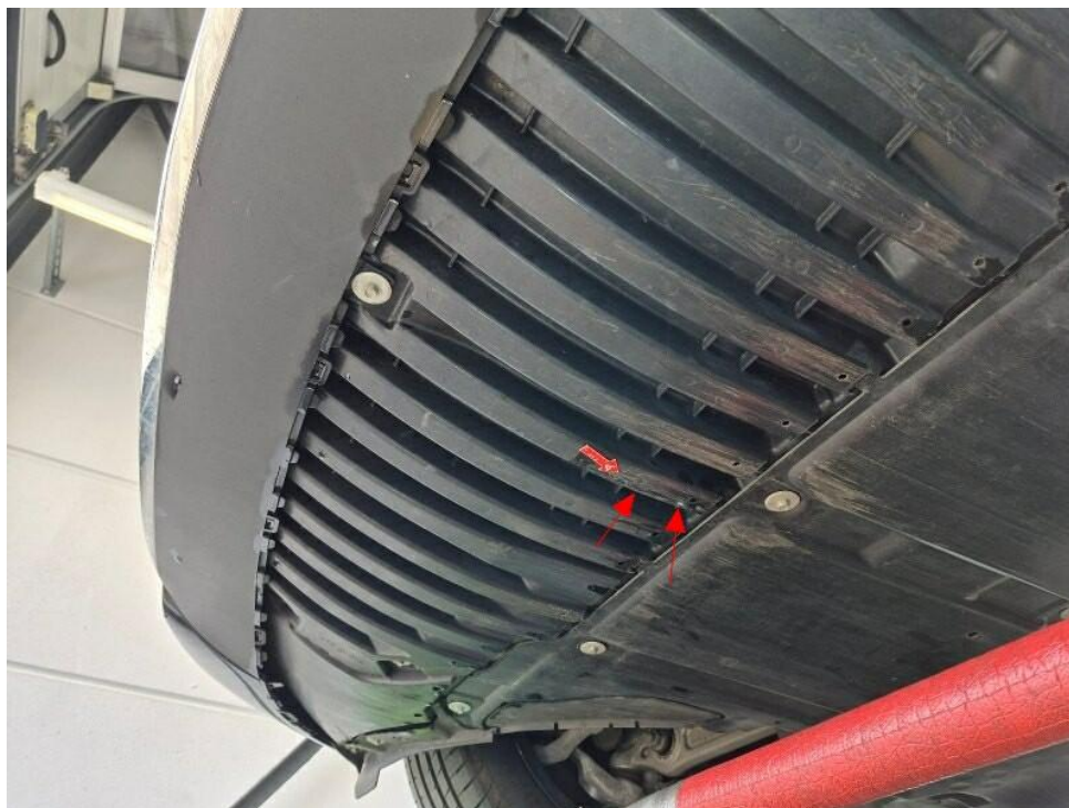
Bild 25 : Stoßfängerverkleidung vorn Schließteil unten gebrochen (Aufsetzschaden)
