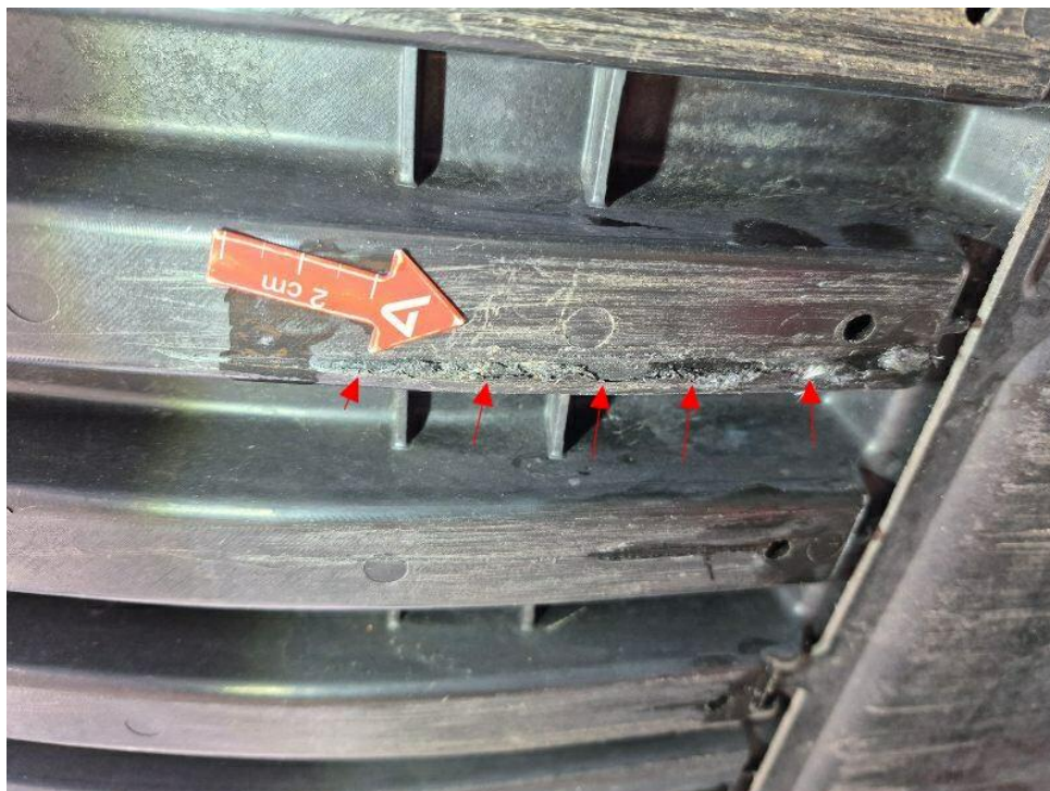
Bild 26 : Stoßfängerverkleidung vorn Schließteil unten gebrochen (Aufsetzschaden)
