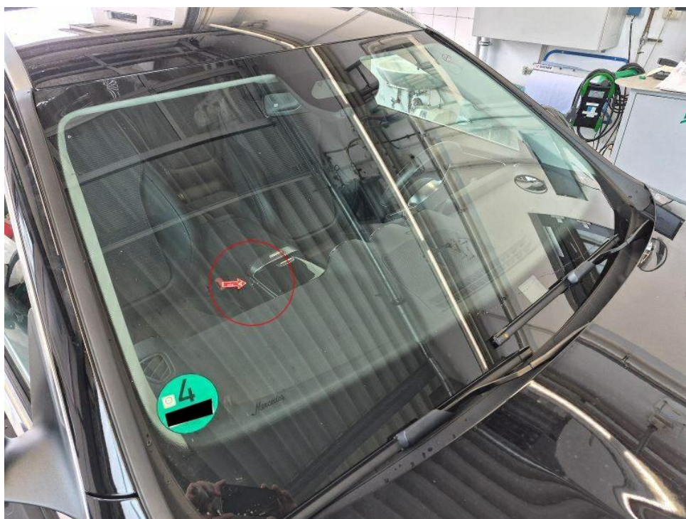
Bild 14 : Frontscheibe Steinschläge mit Rissbildung
