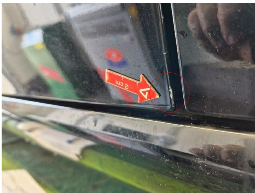
Bild 22 : Tür vorn links Türkante hinten unten partiell verschrammt
