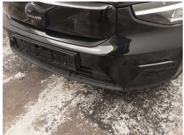
Beschädigung #6: Stossfänger vorn: Spoiler - verkratzt / versch... - erneuern
