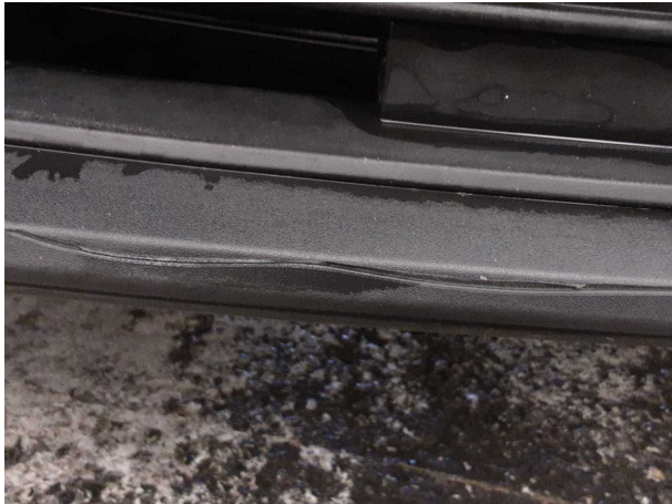
Beschädigung #6: Stossfänger vorn: Spoiler - verkratzt / verschürft - erneuern
