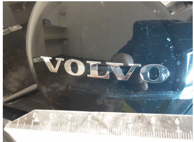
Beschädigung #5: Frontmaske: Emblem - verkratzt / verschürft - erneuern
