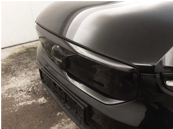
Beschädigung #9: Stossfänger vorn: Grill - verkratzt / verschürft - instandsetzen und lackieren
