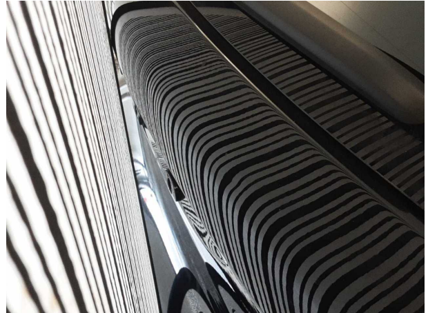
Beschädigung #1: Heckklappe/-tür: Heckklappe - Delle(n) - sanft instandsetzen
