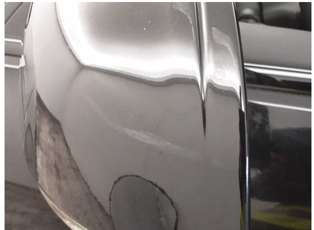
Beschädigung #7: Außenspiegel links: Abdeckkappe - verkratzt / verschürft - instandsetzen und lackieren
