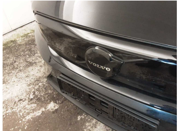
Beschädigung #5: Frontmaske: Emblem - verkratzt / verschürft - erneuern
