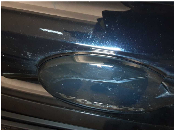
Beschädigung #5: Frontmaske: Emblem - verkratzt / verschürft - erneuern
