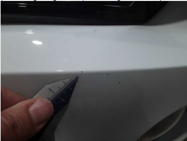
Beschädigung #1: Stossfänger vorn: Stossfänger vorn (Steinschlag nachgearbeitet) - Lackmangel - Smart Repair
