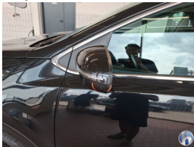
1. Außenspiegel Gehäuse - Links Abschürfung - Smart Repair
