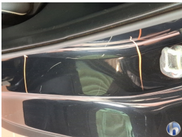
3. Türeinstieg Hinten - Links Kratzer - Smart Repair
