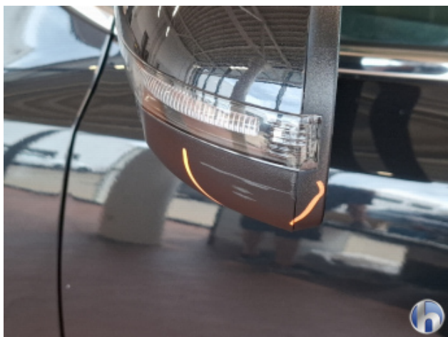
1. Außenspiegel Gehäuse - Links Abschürfung - Smart Repair
