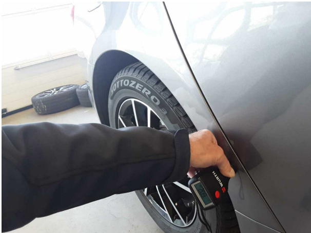
Nachlackierung 1: Seitenwand rechts, Tür hinten rechts
