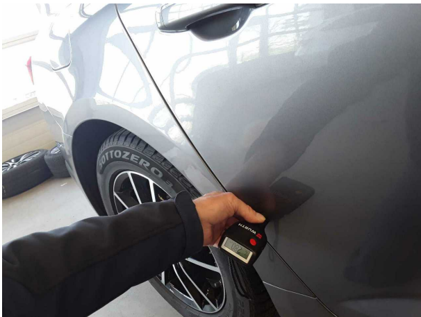
Nachlackierung 1: Seitenwand rechts, Tür hinten rechts
