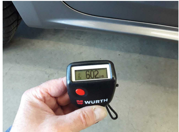
Nachlackierung 1: Seitenwand rechts, Tür hinten rechts
