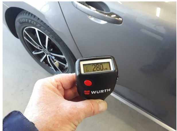
Nachlackierung 1: Seitenwand rechts, Tür hinten rechts
