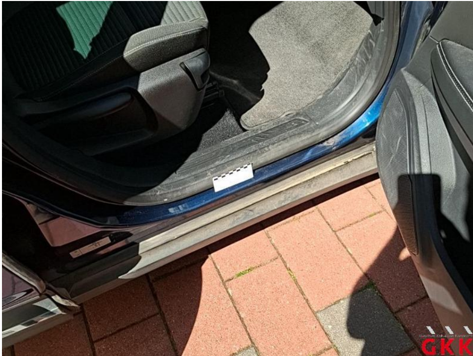
Bild 25. Tür vorne rechts, Einstieg, verkratzt, lackieren
