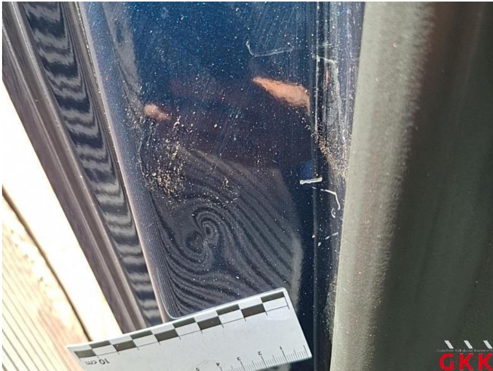
Bild 24. Tür hinten rechts, Einstieg, beschädigt, instand setzen - lackieren
