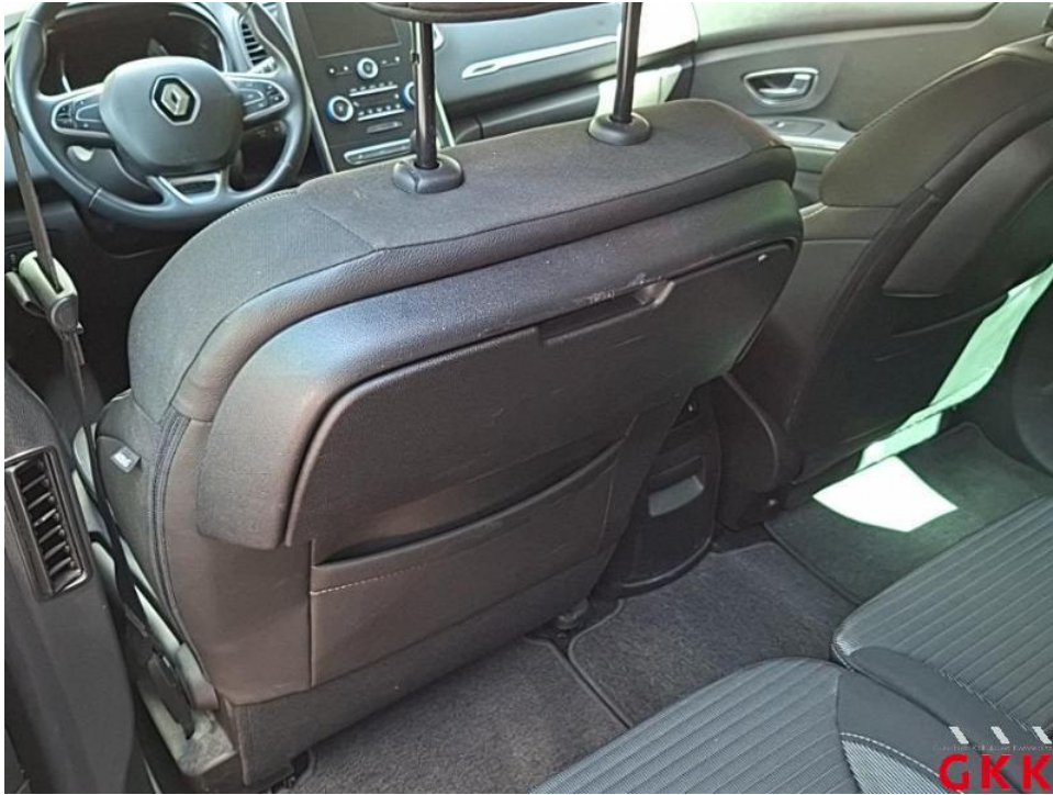
Bild 53. Sitz vorne links, Ablagefach, beschädigt, ersetzen
