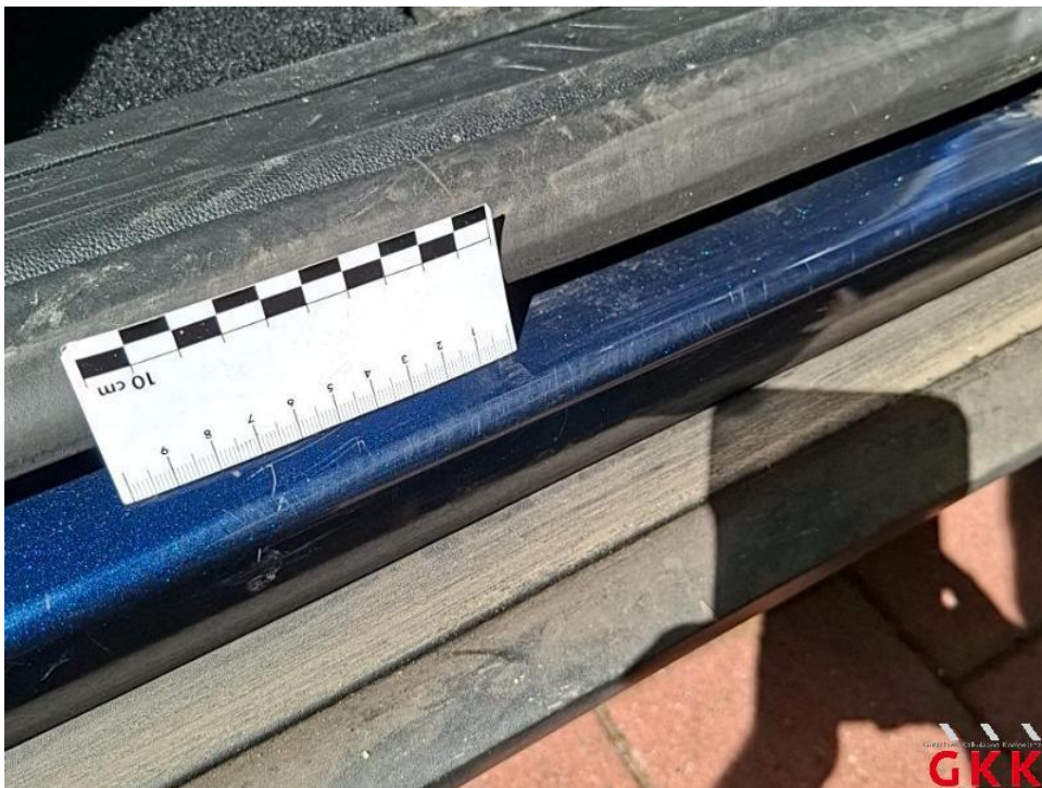
Bild 26. Tür vorne rechts, Einstieg, verkratzt, lackieren
