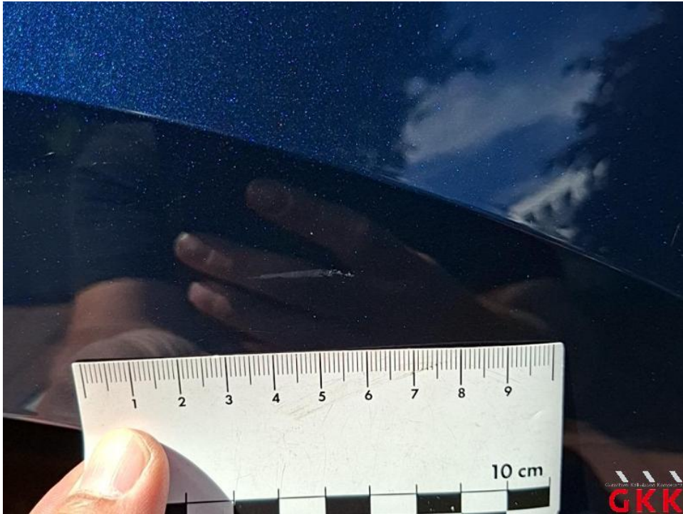
Bild 31. Kotflügel vorne rechts, verkratzt, auslegen, schleifen, polieren
