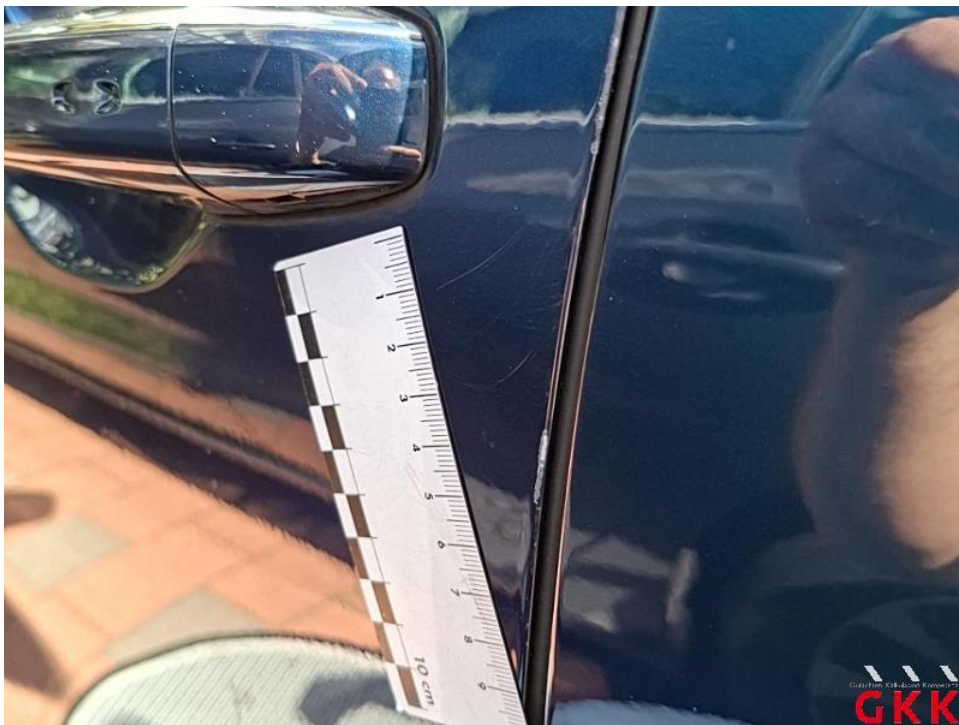
Bild 50. Tür vorne links, verkratzt, lackieren
