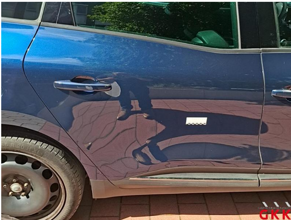
Bild 38. Tür hinten rechts, verkratzt, lackieren
