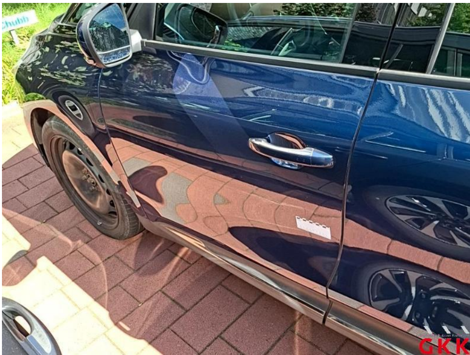
Bild 48. Tür vorne links, verkratzt, lackieren
