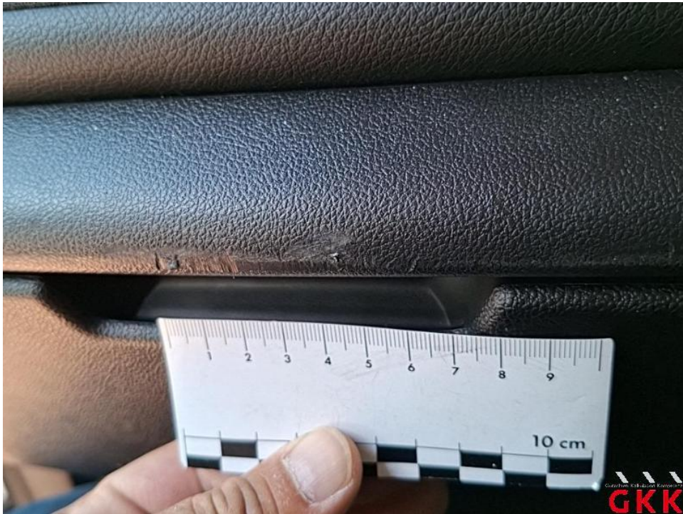
Bild 54. Sitz vorne links, Ablagefach, beschädigt, ersetzen
