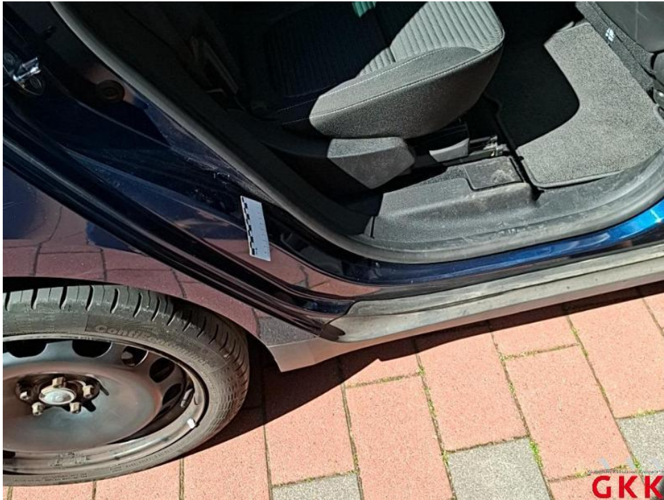
Bild 23. Tür hinten rechts, Einstieg, beschädigt, instand setzen - lackieren
