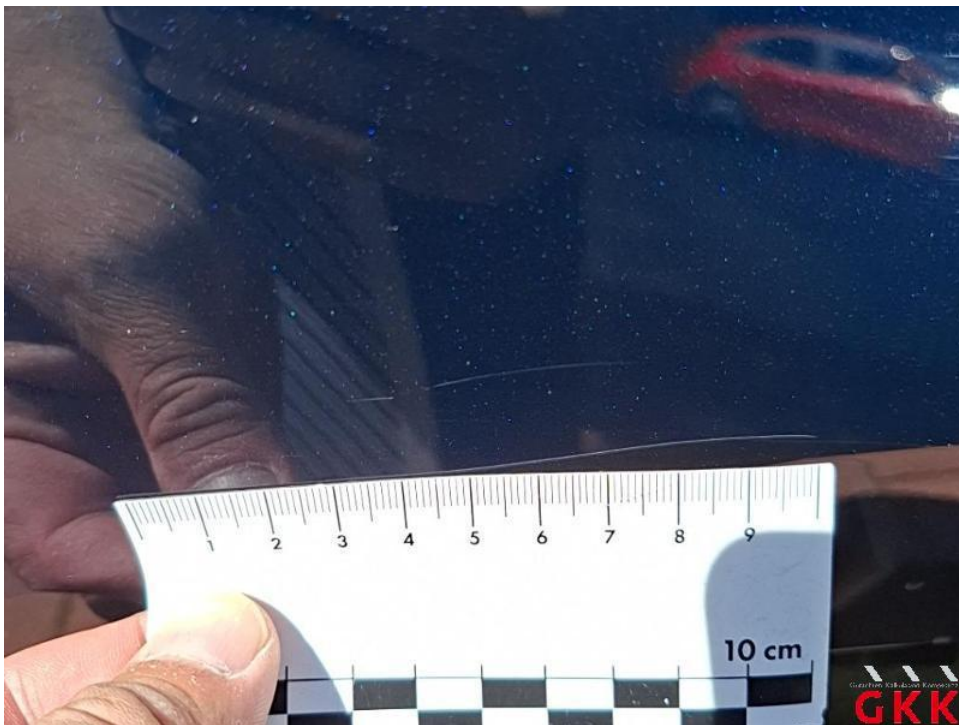
Bild 30. Kotflügel vorne rechts, verkratzt, auslegen, schleifen, polieren
