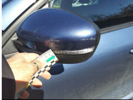
Indicatore di direzione / Sinistro / Rotto
