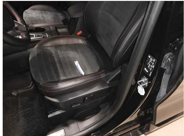
Beschädigung #3: Sitz vorn: Sitzbezug links - gebrochen / gerissen - erneuern
