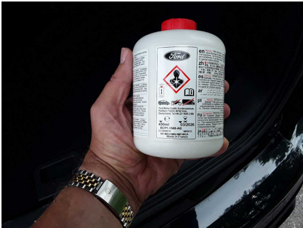
Beschädigung #2: Ausrüstung: Tirefit Füllmittel - abgelaufen - erneuern
