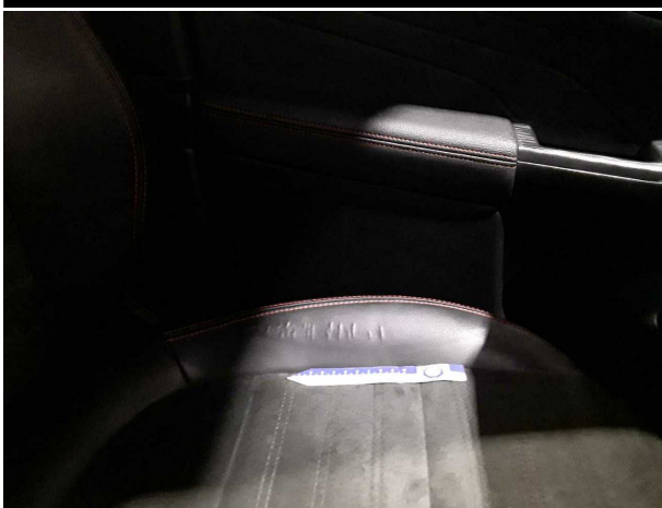
Beschädigung #3: Sitz vorn: Sitzbezug links - gebrochen / gerissen - erneuern
