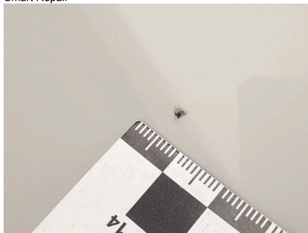
Beschädigung #7: Tür vorn rechts: Tür - verkratzt / verschürft - lackieren
