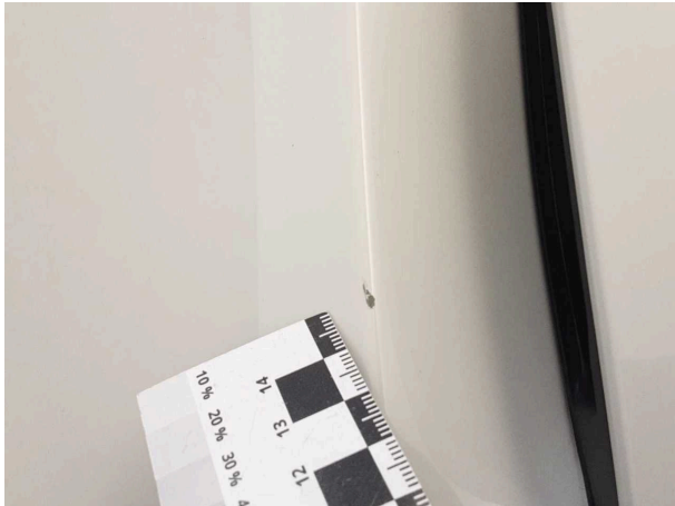
Beschädigung #3: Tür hinten rechts: Tür - verkratzt / verschürft - Smart Repair
