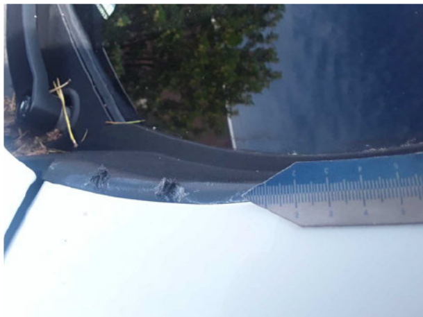
Beschädigung #2: Verkleidungen/Abdeckungen: Zierleiste / Dekorleiste - Kratzer - erneuern
