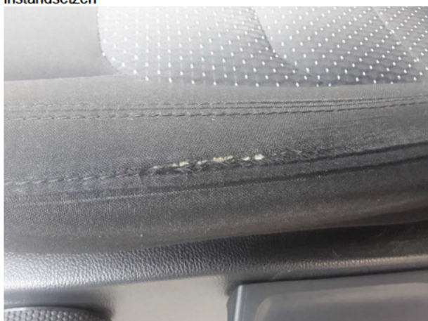
Beschädigung #4: Sitz vorn: Sitzbezug links - gebrochen / gerissen - Smart Repair
