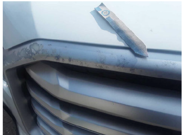
Beschädigung #5: Motorhaube: Kühlergrill - Lackmangel - erneuern
