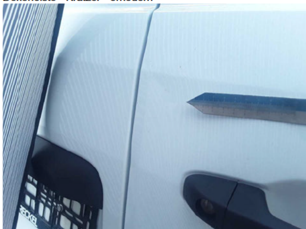
Beschädigung #3: Heckklappe/-tür: Hecktür rechts - Delle(n) - sanft instandsetzen
