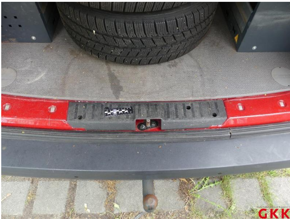
Bild 44. Ladekante, Abdeckung, beschädigt, ersetzen
