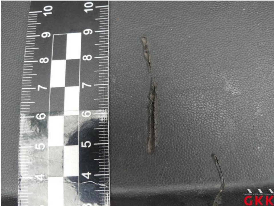
Bild 37. Stoßfänger hinten, Verkleidung -unlackiert-, verkratzt, ersetzen
