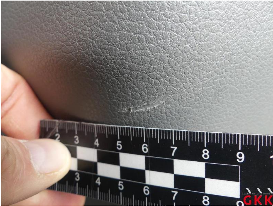
Bild 33. Mittelkonsole, verkratzt, Smartrepair
