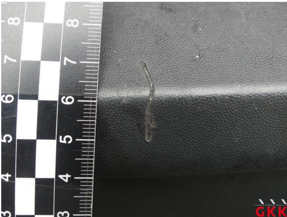
Bild 38. Stoßfänger hinten, Verkleidung -unlackiert-, verkratzt, ersetzen
