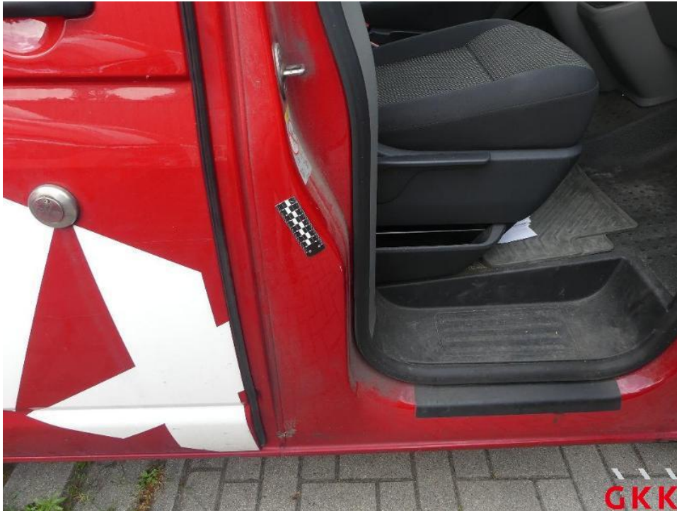
Bild 29. Tür vorne rechts, Einstieg, verkratzt, lackieren
