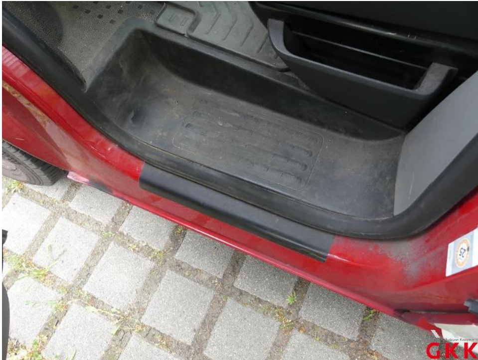
Bild 59. Tür vorne links, Dichtung -Einstieg-, beschädigt, ersetzen
