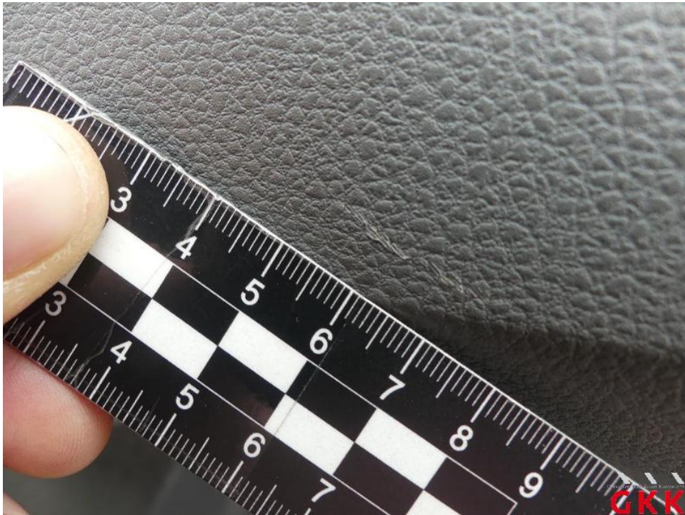
Bild 28. Armaturenbrett, Blende, verkratzt, Smartrepair
