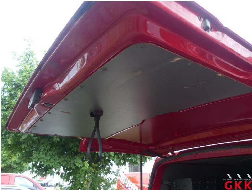
Bild 42. Heckklappe, Innenverkleidung, beschädigt, ersetzen
