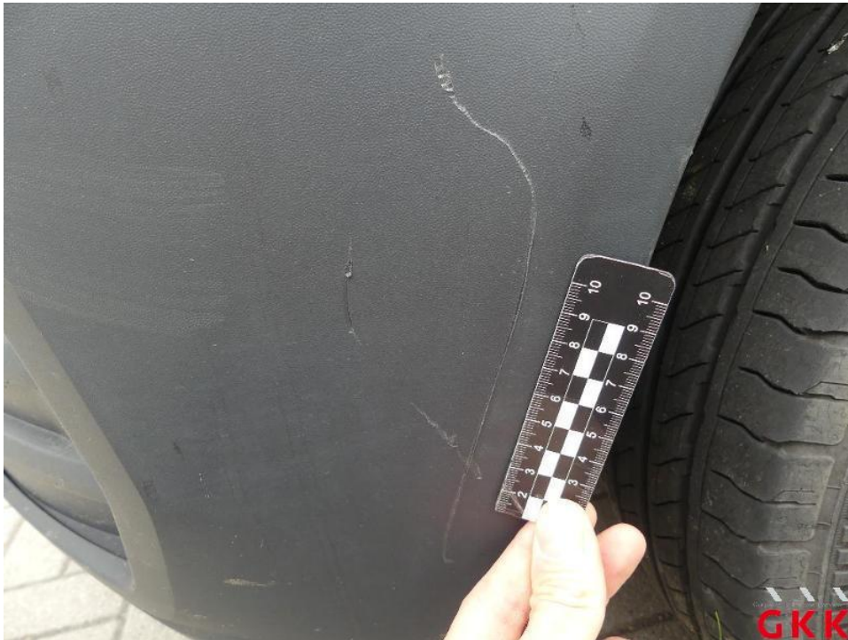
Bild 16. Stoßfänger vorne, Verkleidung -unlackiert-, verkratzt, ersetzen
