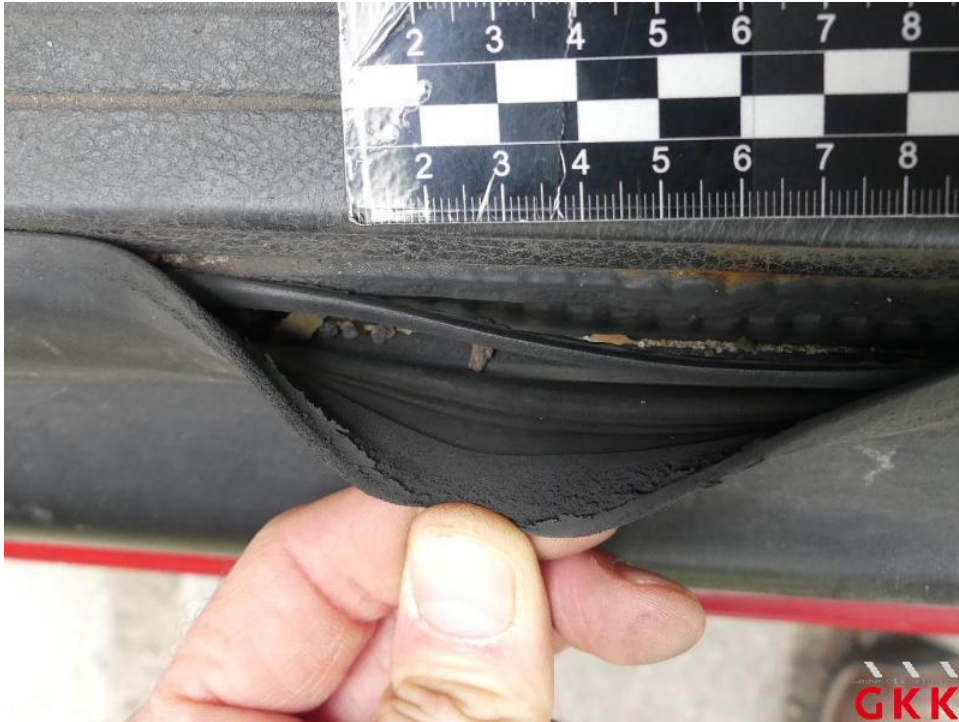
Bild 61. Tür vorne links, Dichtung -Einstieg-, beschädigt, ersetzen
