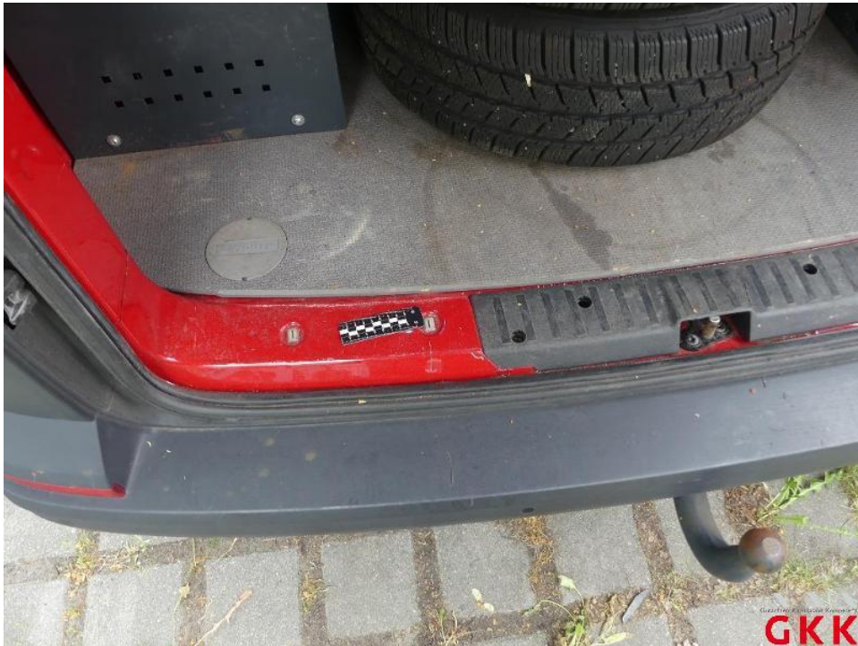
Bild 46. Ladekante, verkratzt, lackieren
