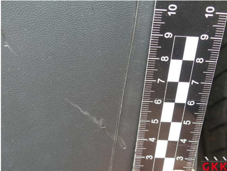
Bild 17. Stoßfänger vorne, Verkleidung -unlackiert-, verkratzt, ersetzen
