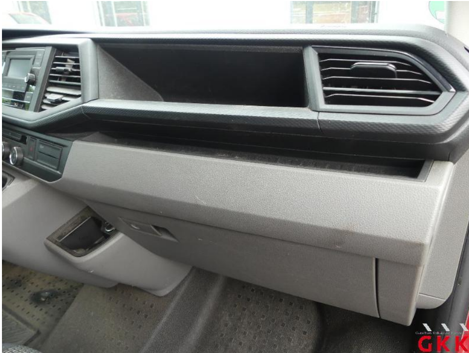
Bild 27. Armaturenbrett, Blende, verkratzt, Smartrepair
