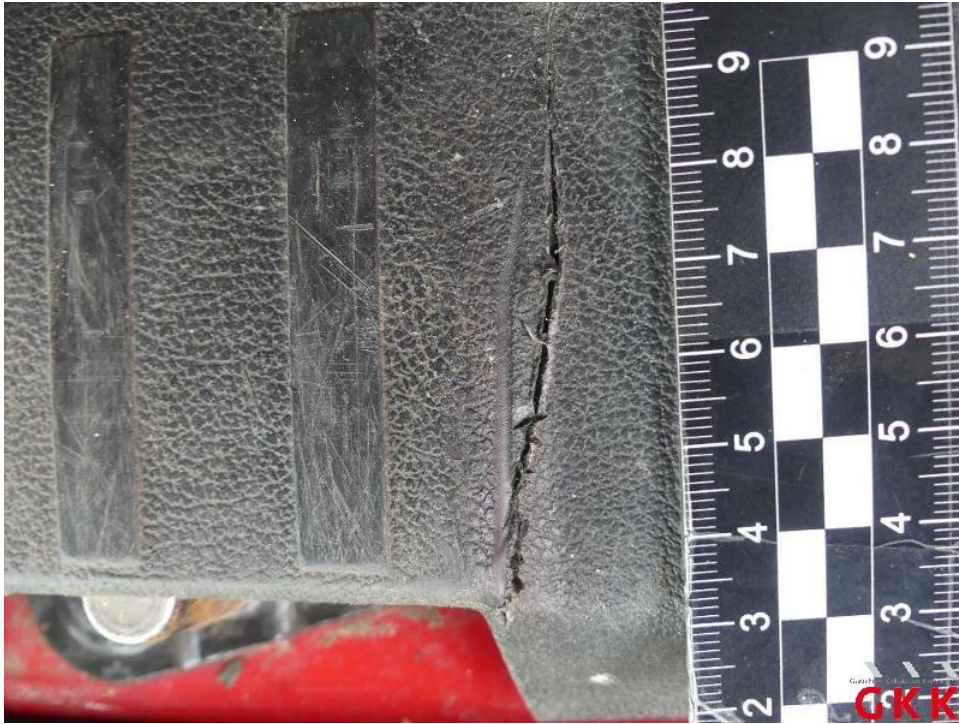
Bild 45. Ladekante, Abdeckung, beschädigt, ersetzen
