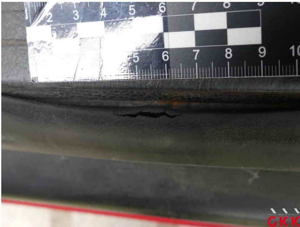
Bild 60. Tür vorne links, Dichtung -Einstieg-, beschädigt, ersetzen
