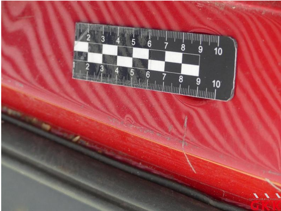
Bild 47. Ladekante, verkratzt, lackieren
