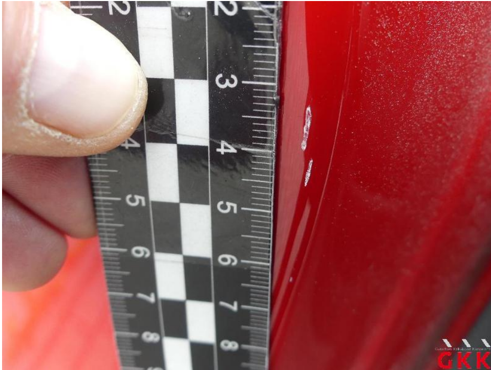
Bild 31. Tür vorne rechts, Einstieg, verkratzt, lackieren
