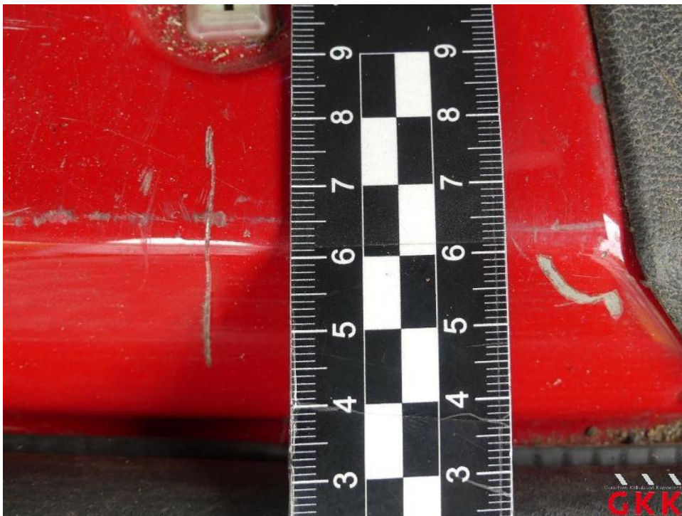
Bild 48. Ladekante, verkratzt, lackieren
