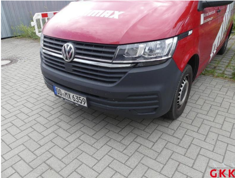
Bild 15. Stoßfänger vorne, Verkleidung -unlackiert-, verkratzt, ersetzen
