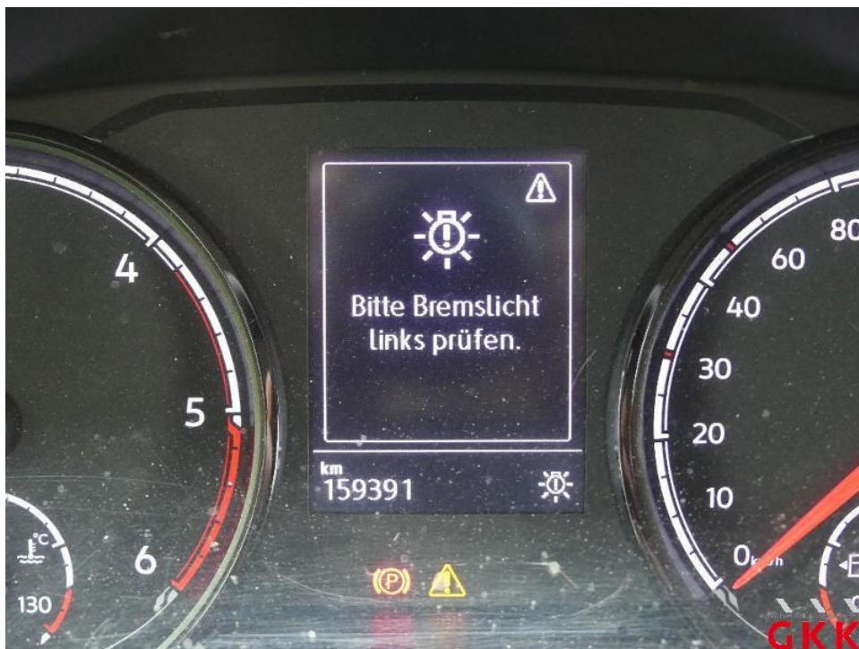
Bild 12. Bordcomputer, Fehlerspeicher, aktiv, auslesen / prüfen
