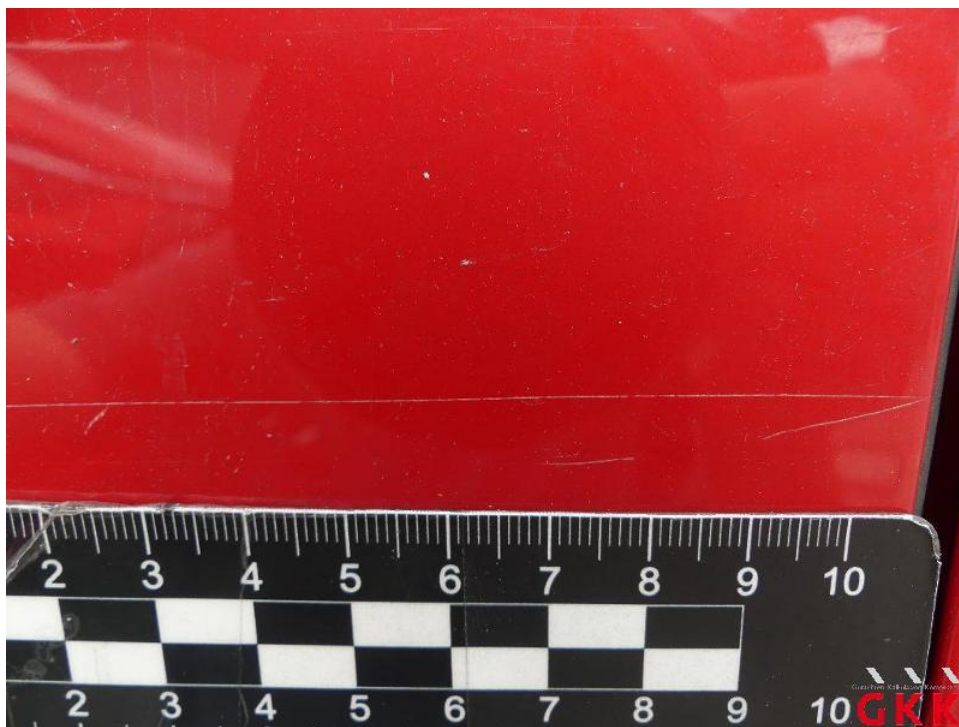
Bild 52. Schiebetür rechts, verkratzt, lackieren
