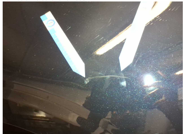
Beschädigung #5: Seitenwand links: Seitenwand - verkratzt / verschürft - lackieren
