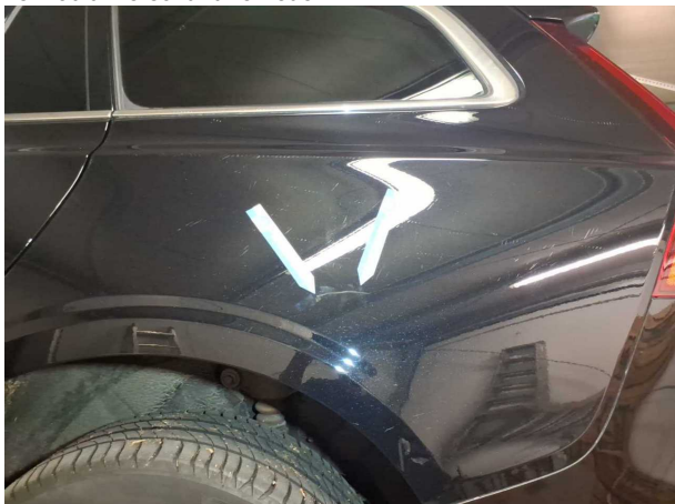
Beschädigung #5: Seitenwand links: Seitenwand - verkratzt / verschürft - lackieren
