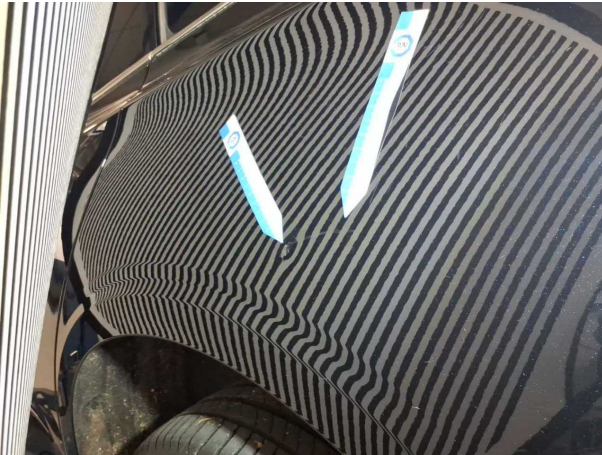
Beschädigung #5: Seitenwand links: Seitenwand - verkratzt / verschürft - lackieren
