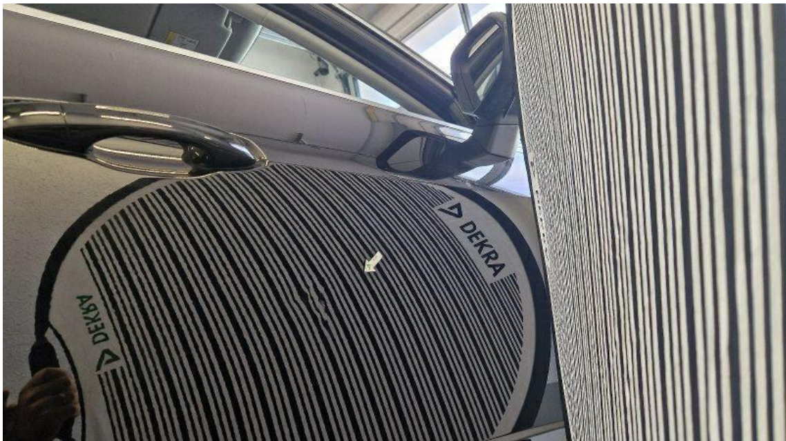
Bild 14 : Tür vorne rechts, deformiert, instandsetzen und lackieren mit Lackaufbau
