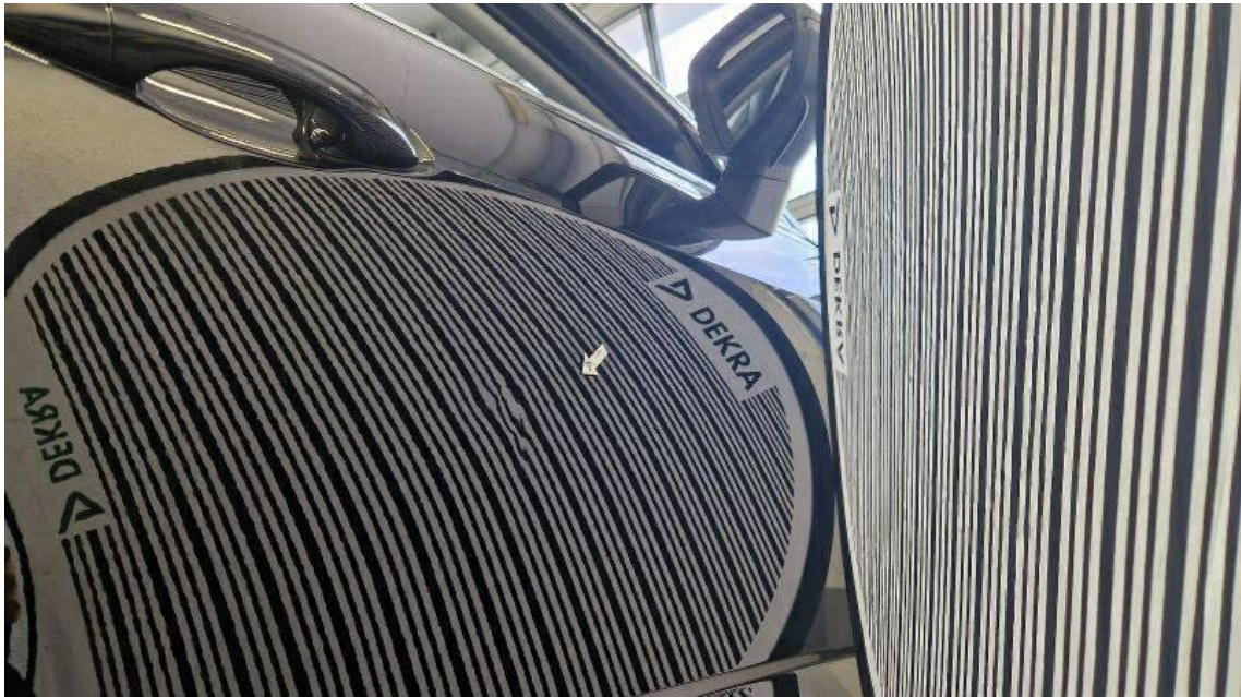
Bild 13 : Tür vorne rechts, deformiert, instandsetzen und lackieren mit Lackaufbau
