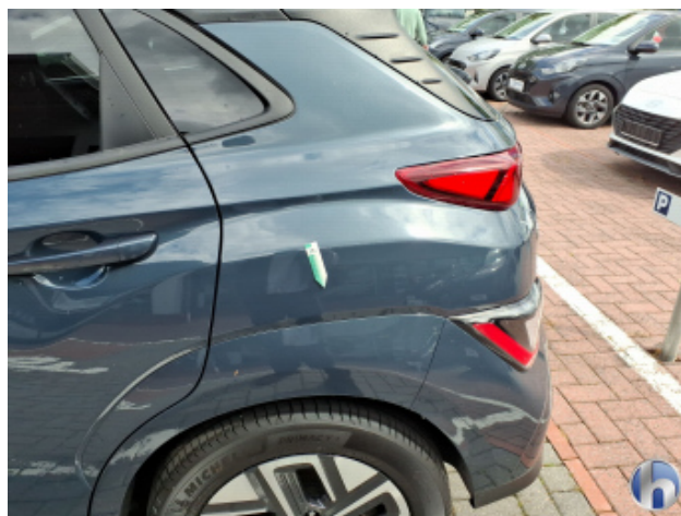
7. Seitenwand - Hinten - Links Kratzer - Smart Repair
