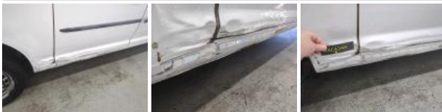
Door trim FR, Broken, Replace
