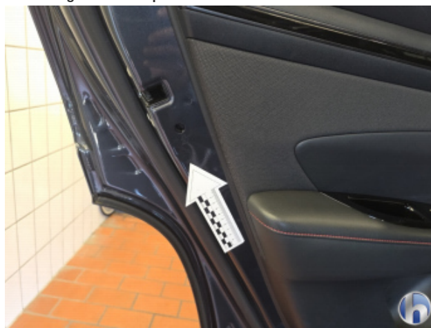
1. C-Säule Hinten - Links Beschädigt - Smart Repair
