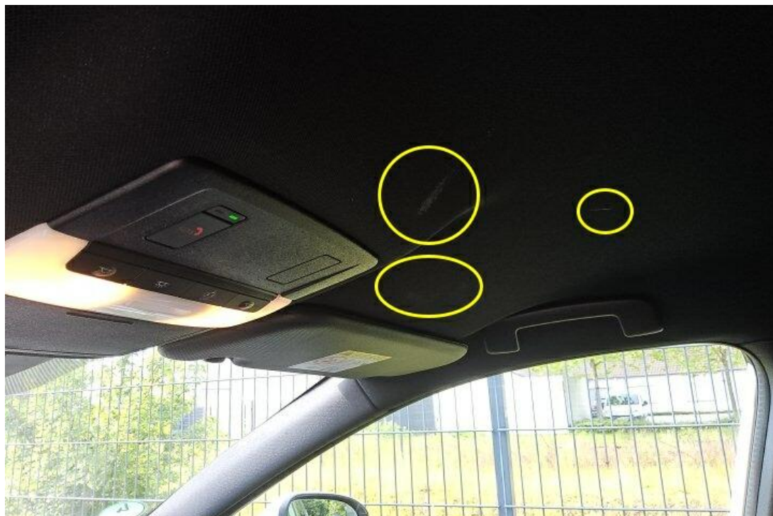
Bild 15 : Dachhimmel, fleckig, reinigen
