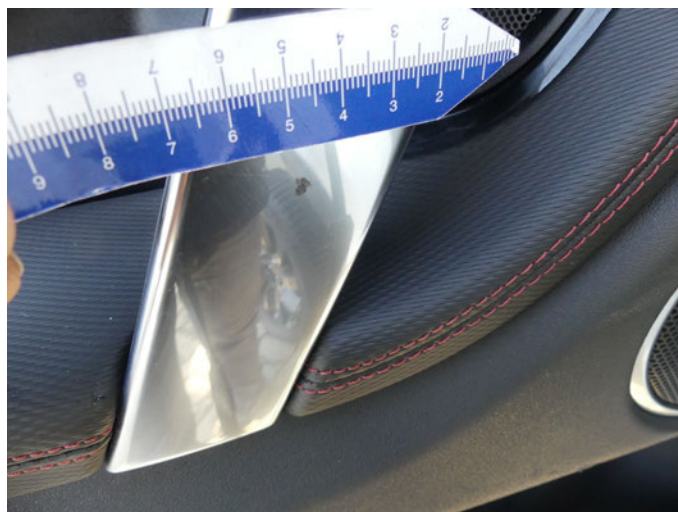
Beschädigung 2: Tür hinten links: Griff innen (Blende) - Kratzer - erneuern
