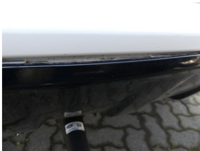
Beschädigung 5: Stossfänger hinten: Abdeckung Stossfänger hinten - gebrochen / gerissen - erneuern
