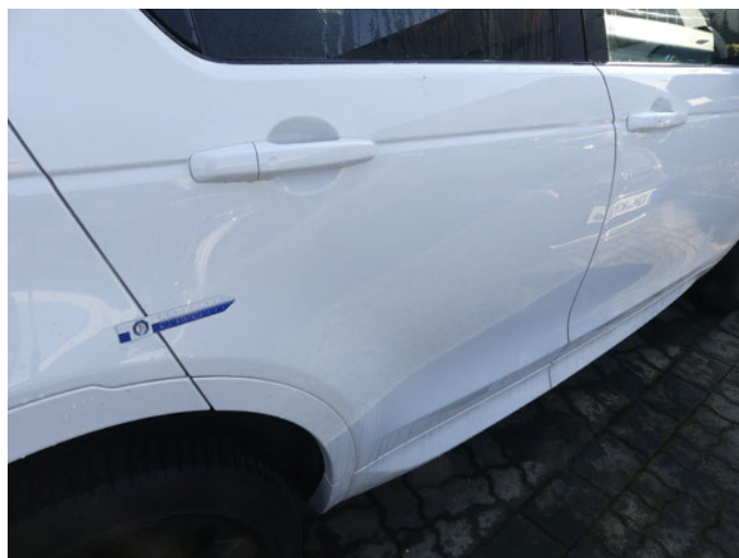
Beschädigung 10: Tür hinten rechts: Tür - Delle / Lackschaden - instandsetzen und lackieren
