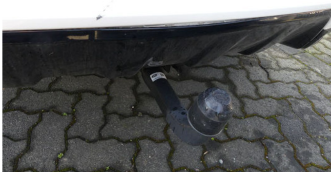
Beschädigung 5: Stossfänger hinten: Abdeckung Stossfänger hinten - gebrochen / gerissen - erneuern
