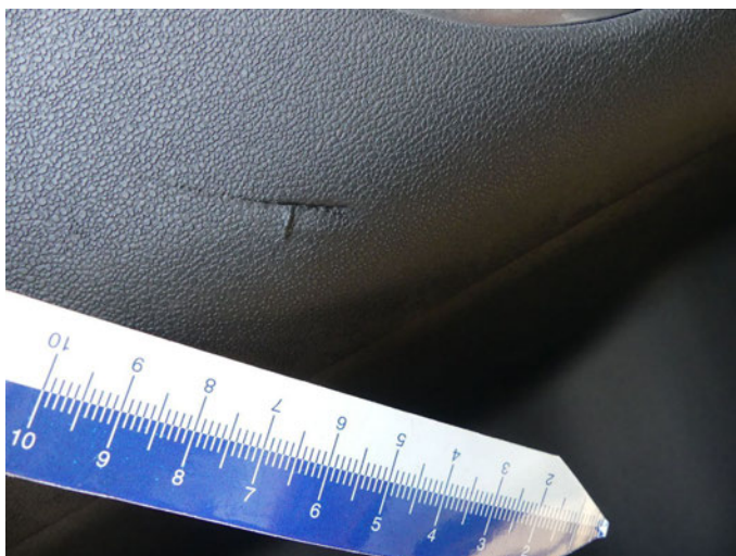
Beschädigung 9: Verkleidungen/Abdeckungen: Türverkleidung hinten links - gebrochen / gerissen - erneuern
