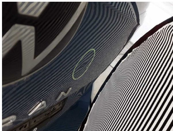
Beschädigung #4: Heckklappe/-tür: Heckklappe - Delle(n) - sanft instandsetzen
