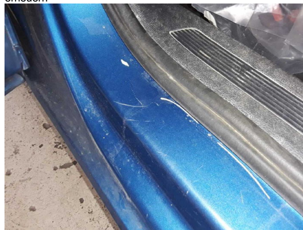
Beschädigung #8: Schweller links: Einstieg - Delle / Lackschaden - instandsetzen und lackieren
