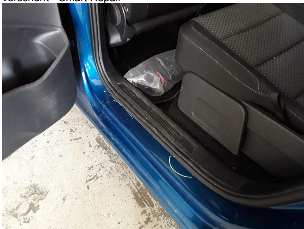
Beschädigung #8: Schweller links: Einstieg - Delle / Lackschade... instandsetzen und lackieren
