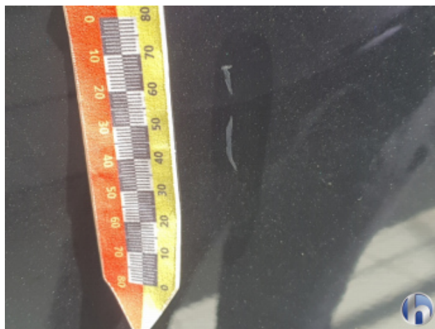
3. Seitenwand - Hinten - Links Kratzer - Smart Repair
