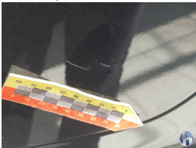
3. Seitenwand - Hinten - Links Kratzer - Smart Repair
