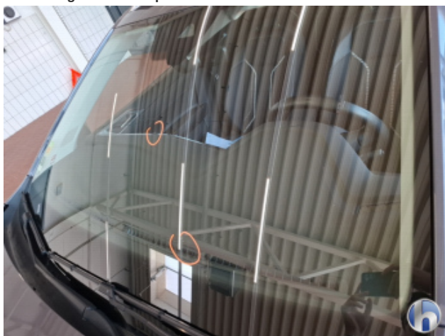
10. Windschutzscheibe Steinschlag - Smart Repair
