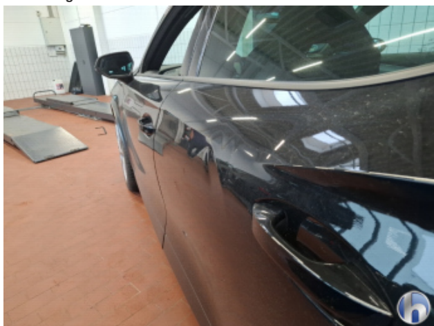
2. Tür Hinten - Links Beschädigt - Erneuern
