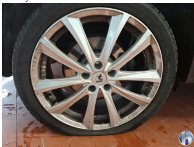
1. Felge Hinten - Rechts Beschädigt - Erneuern
