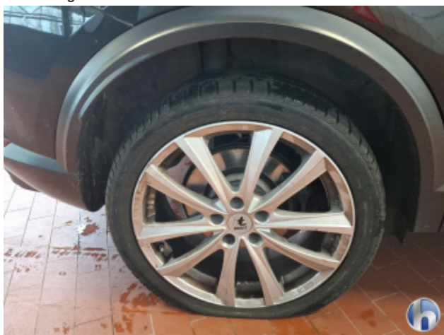
4. Reifen Hinten - Rechts Beschädigt - Erneuern
