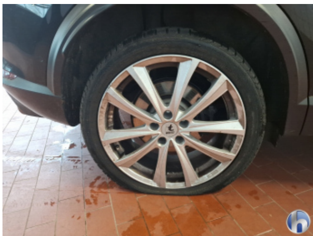
4. Reifen Hinten - Rechts Beschädigt - Erneuern
