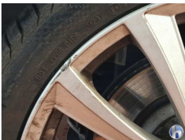
1. Felge Hinten - Rechts Beschädigt - Erneuern
