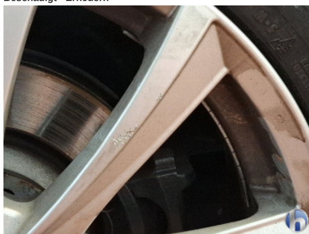
1. Felge Hinten - Rechts Beschädigt - Erneuern
