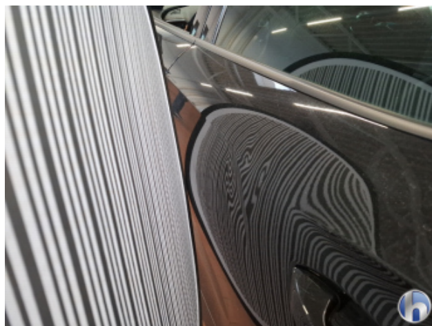
2. Tür Hinten - Links Beschädigt - Erneuern
