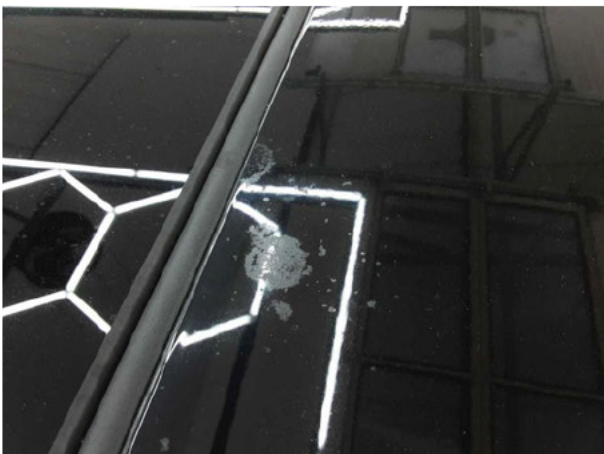
Beschädigung #2: Fahrzeugdach: Dach - Lackmangel - lackieren
