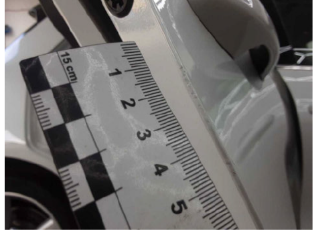
Beschädigung #1: Tür hinten rechts: Türkante - Kratzer - Smart Repair
