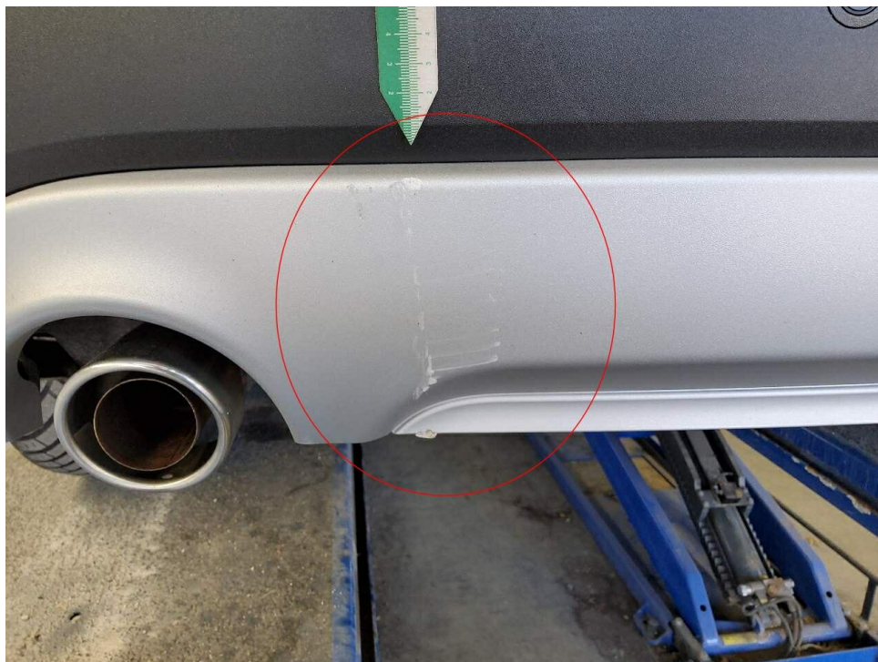
Bild 12 : Stoßfänger hinten Unterteil Kratzer und eingedellt
