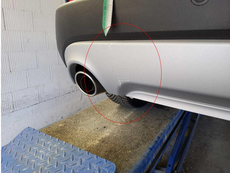
Bild 13 : Stoßfänger hinten Unterteil Kratzer und eingedellt
