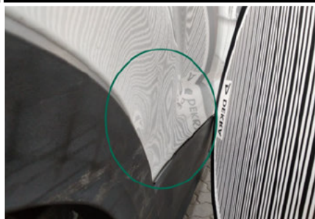
Seitenwand / Unten Hinten Rechts / Delle
