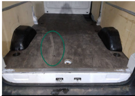
Holzboden / Hinten / Kratzer
