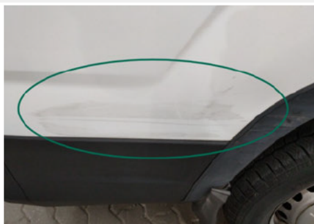
Seitenwand / Unten Hinten Rechts / Delle
