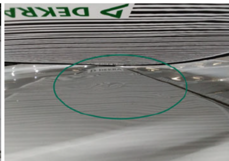
Dach / Vorne / Delle
