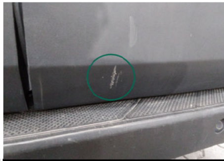
Zerleiste Heckklappe / Unten Rechts / Kratzer
