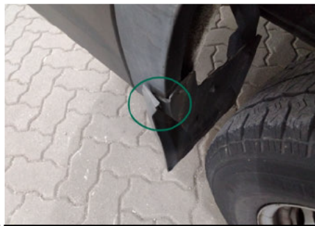
Spritzschutz / Hinten Rechts / Gebrochen
