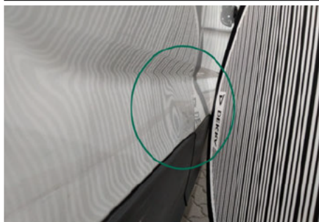
Seitenwand / Unten Hinten Rechts / Delle
