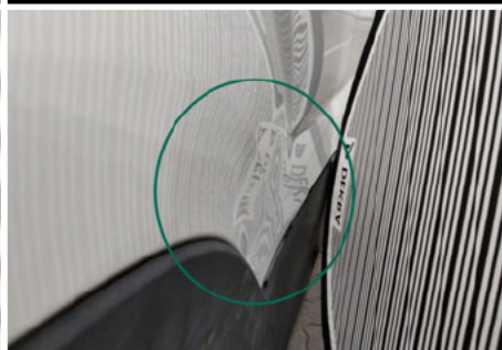
Seitenwand / Unten Hinten Rechts / Delle
