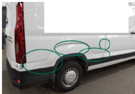
Seitenwand / Unten Hinten Rechts / Delle
