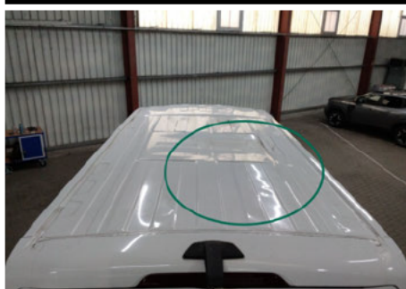
Dach / Hinten / Delle
