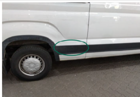
Zierleiste Seitenwand / Hinten Rechts / Delle
