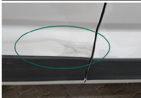
Seitenwand / Unten Hinten Rechts / Delle
