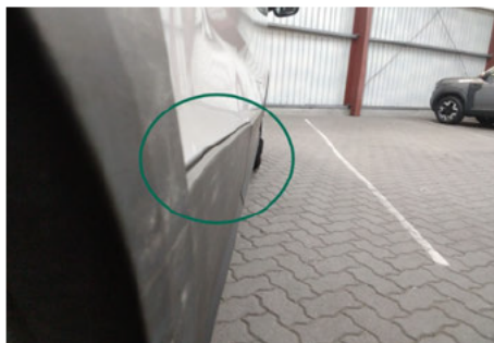
Zierleiste Seitenwand / Hinten Rechts / Delle
