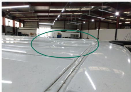
Dach / Hinten / Delle
