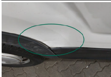
Seitenwand / Unten Hinten Rechts / Delle
