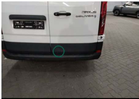
Zerleiste Heckklappe / Unten Rechts / Kratzer
