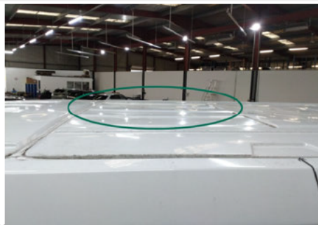
Dach / Hinten / Delle
