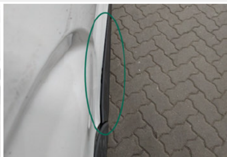
Zierleiste Seitenwand / Hinten Rechts / Delle
