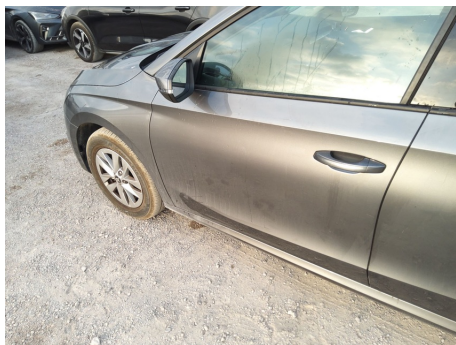
Puerta / Delantero Izquierdo / Abolladura
