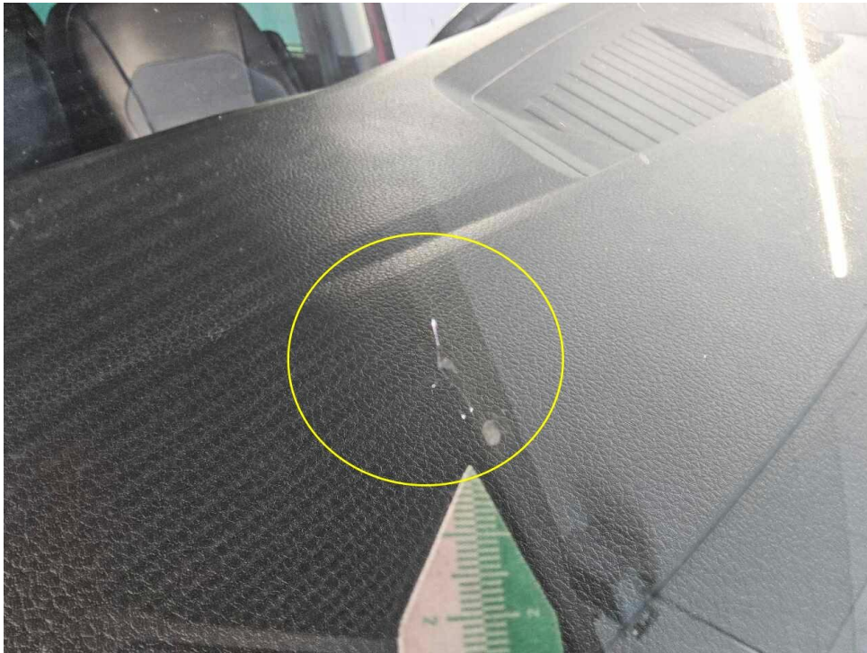
Bild 19 : Frontscheibe Steinschlag mit Rissbildung
