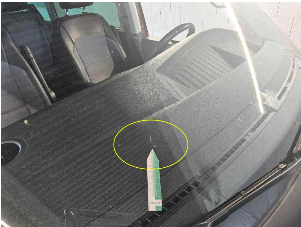
Bild 20 : Frontscheibe Steinschlag mit Rissbildung
