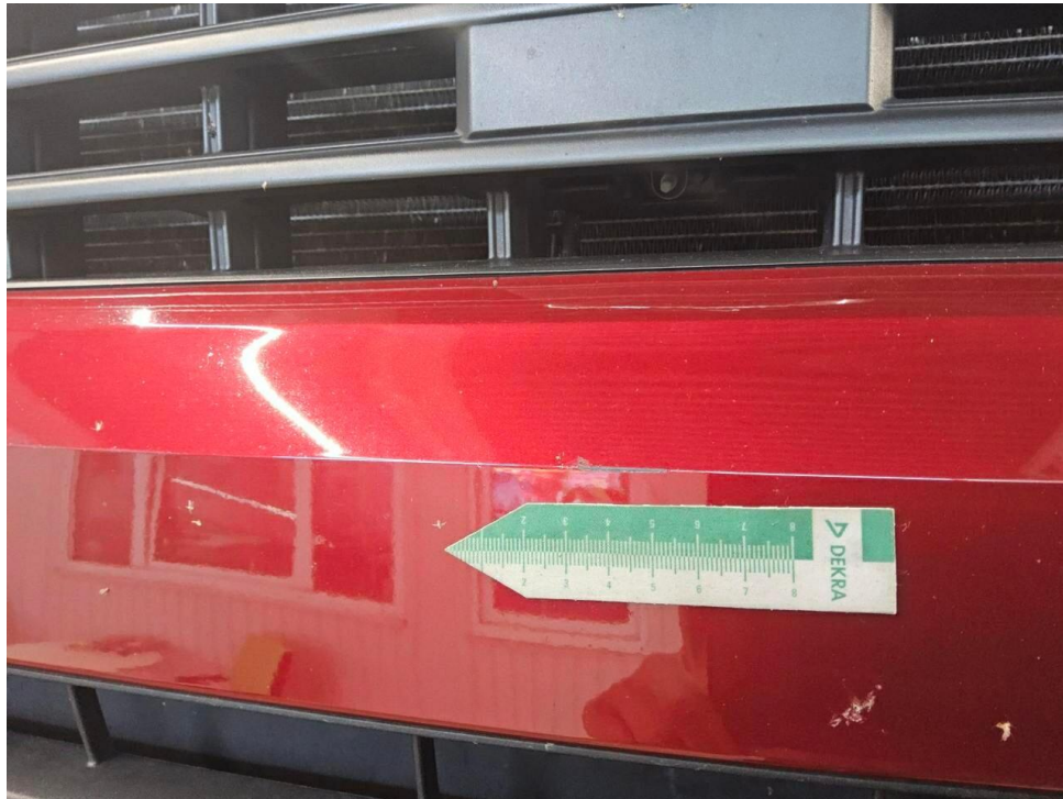
Bild 15 : Stoßfänger vorne Lackierung, zerkratzt, Gebrauchsspur
