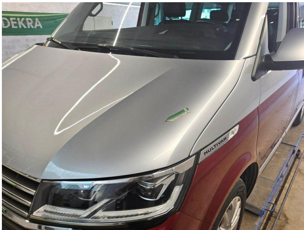
Bild 16 : Motorhaube Lackierung, Steinschlag, Gebrauchsspur
