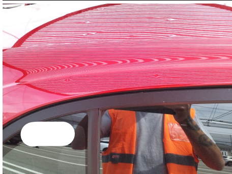
Montante tetto / Destro / Rientranza da Grandine
