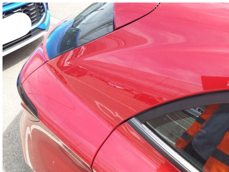
Parafango / Posteriore Destro / Rientranza
