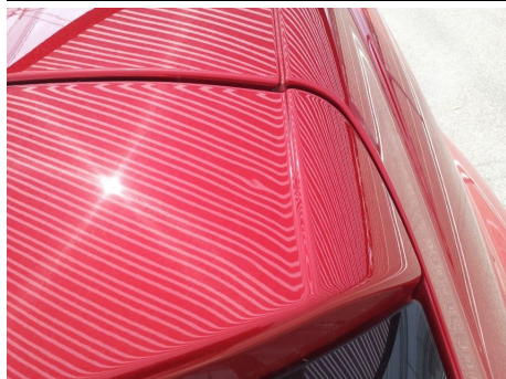
Spoiler portello / Posteriore / Rientranza da Grandine
