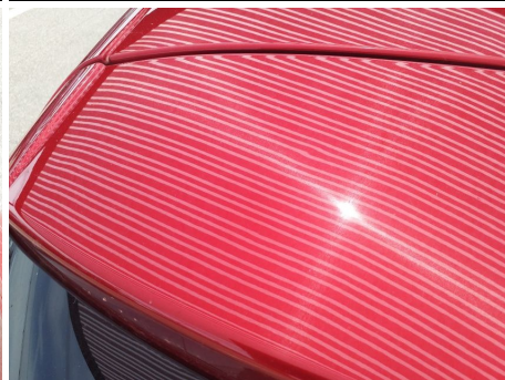
Spoiler portello / Posteriore / Rientranza da Grandine
