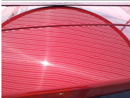
Spoiler portello / Posteriore / Rientranza da Grandine
