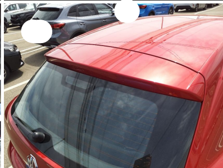
Spoiler portello / Posteriore / Rientranza da Grandine
