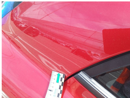
Parafango / Posteriore Destro / Rientranza
