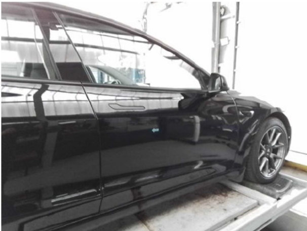
Beschädigung #6: Tür vorn rechts: Tür - Kratzer - lackieren
