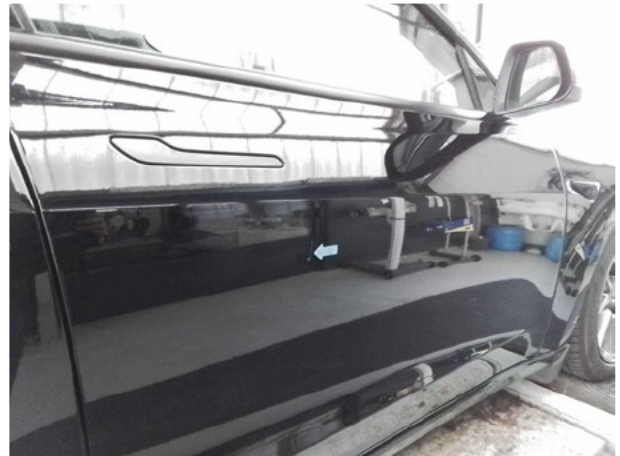
Beschädigung #6: Tür vorn rechts: Tür - Kratzer - lackieren
