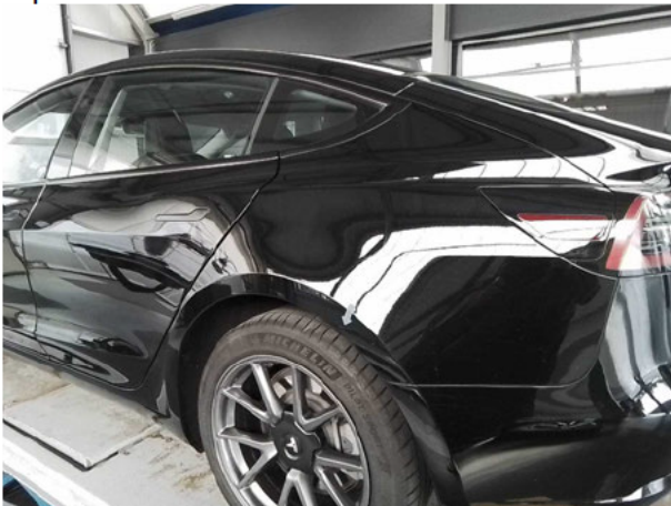
Beschädigung #4: Seitenwand links: Seitenwand - Kratzer - Smart Repair
