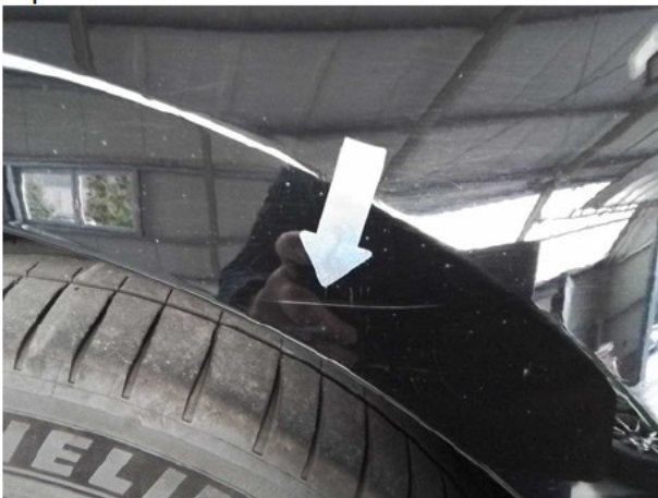
Beschädigung #4: Seitenwand links: Seitenwand - Kratzer - Smart Repair
