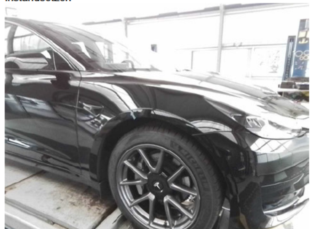
Beschädigung #3: Kotflügel rechts: Kotflügel rechts - Kratzer - Smart Repair
