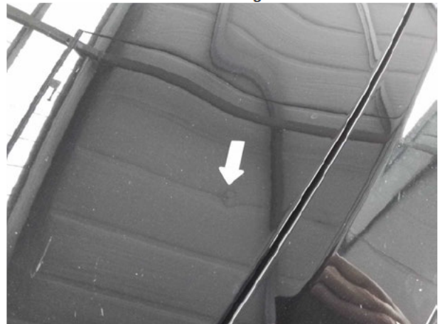
Beschädigung #2: Motorhaube: Motorhaube - Delle(n) - sanft instandsetzen
