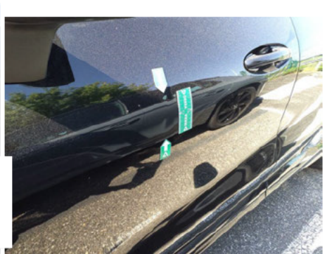
Porte / Avant Gauche / Enfoncement
