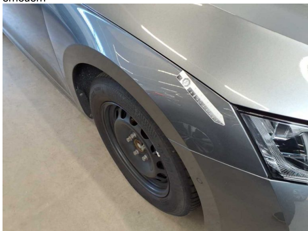
Beschädigung #2: Kotflügel rechts: Kotflügel rechts - Kratzer - instandsetzen und lackieren
