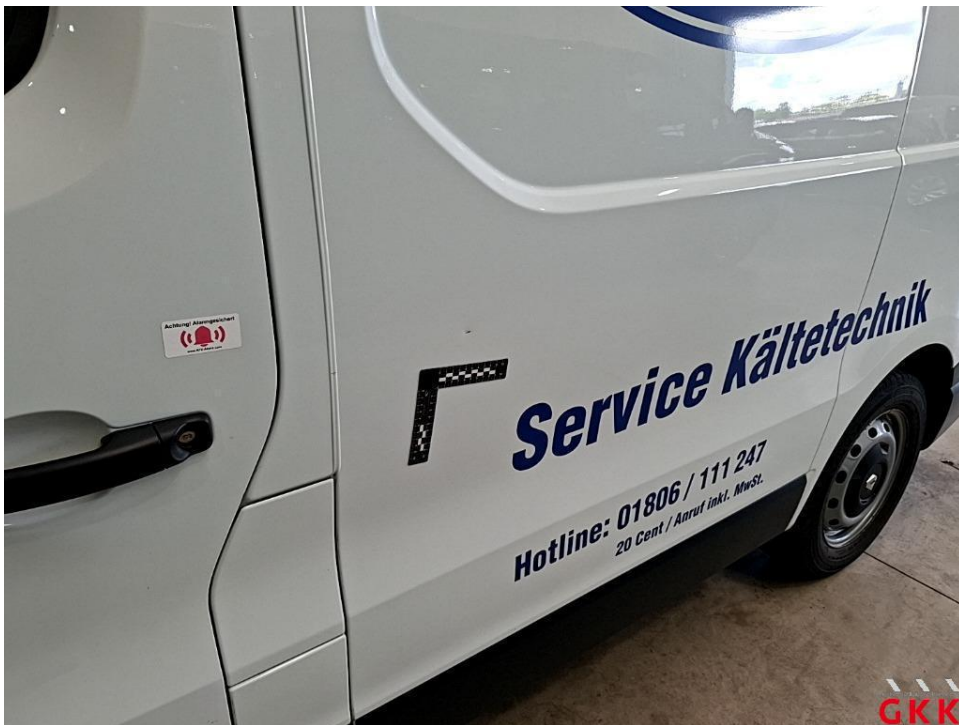
Bild 20. Seitenwand links, Mitte, beschädigt, kalt drücken
