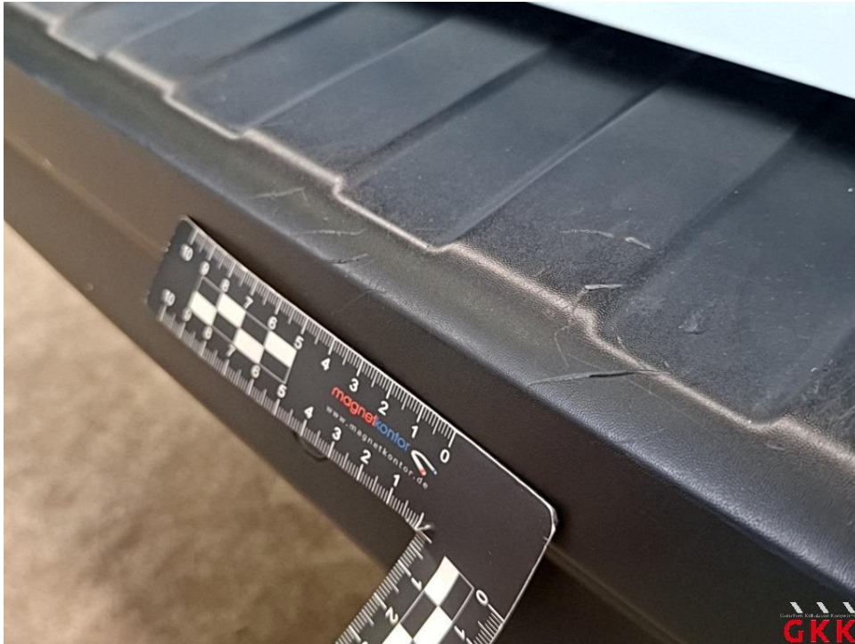
Bild 25. Stoßfänger hinten, Verkleidung -unlackiert-, verkratzt, Smartrepair
