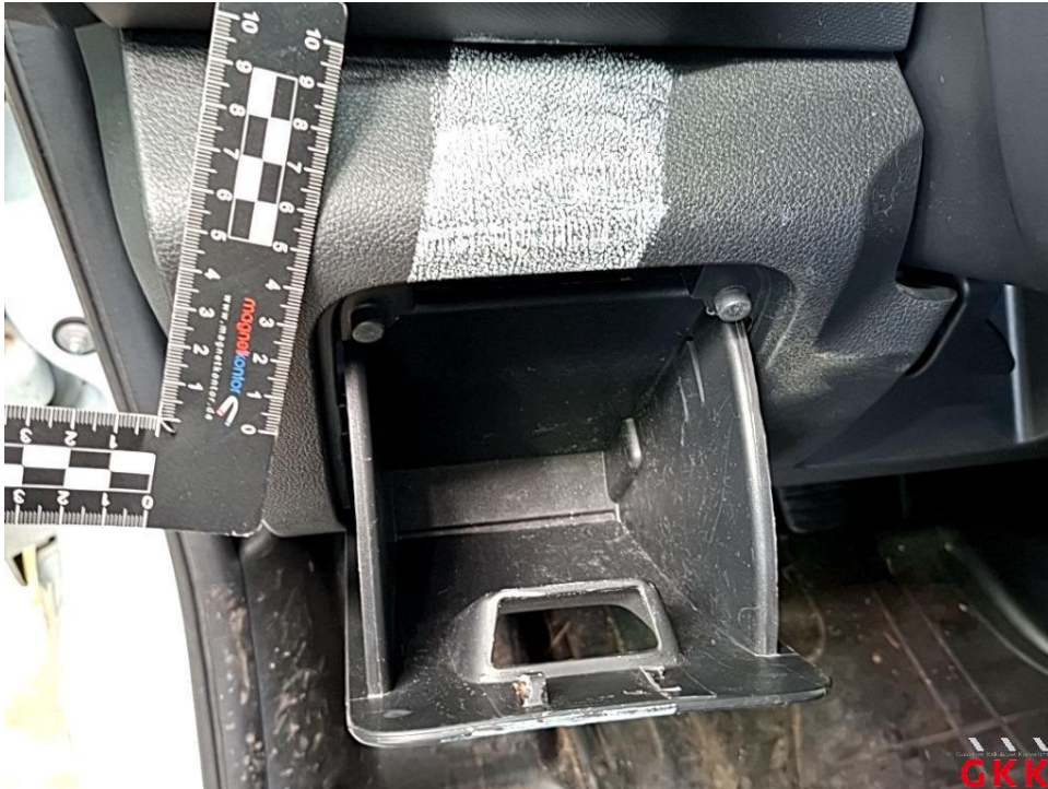
Bild 15. Armaturenbrett, Ablagefach, beschädigt, ersetzen
