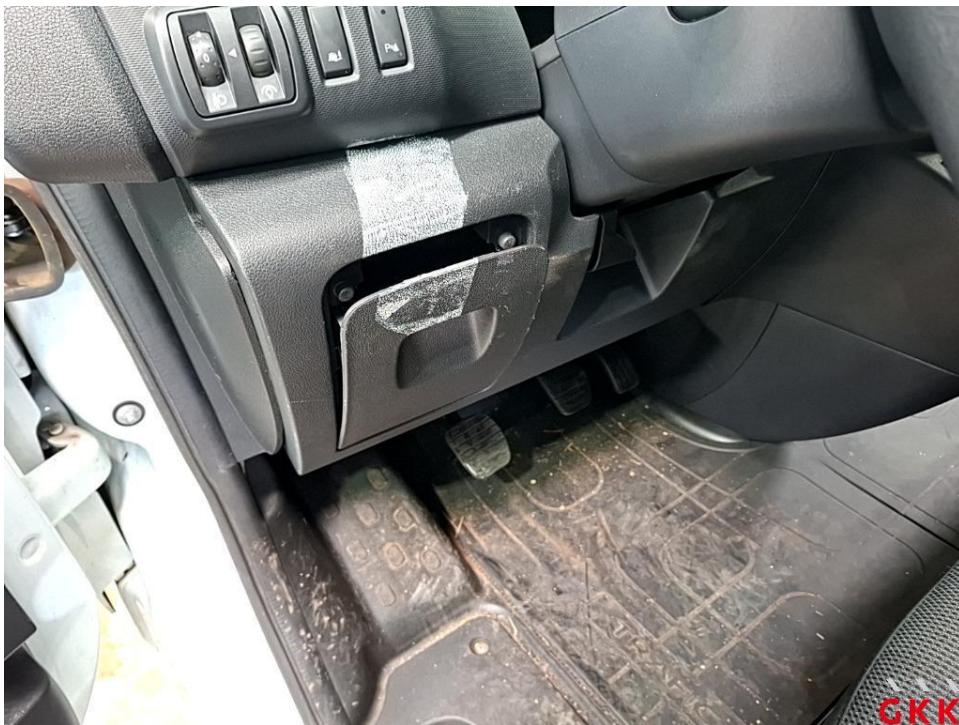
Bild 14. Armaturenbrett, Ablagefach, beschädigt, ersetzen
