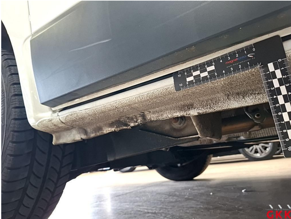
Bild 27. Schweller rechts, hinten, beschädigt, Smartrepair
