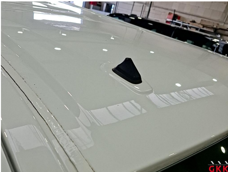
Bild 28. Antenne, Stab, fehlt, ersetzen
