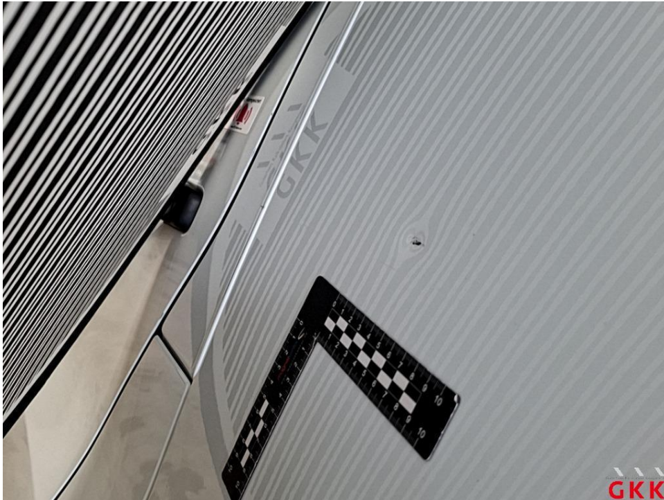
Bild 21. Seitenwand links, Mitte, beschädigt, kalt drücken
