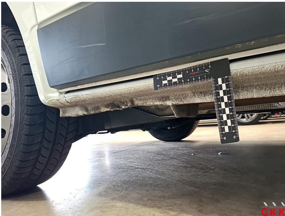
Bild 26. Schweller rechts, hinten, beschädigt, Smartrepair
