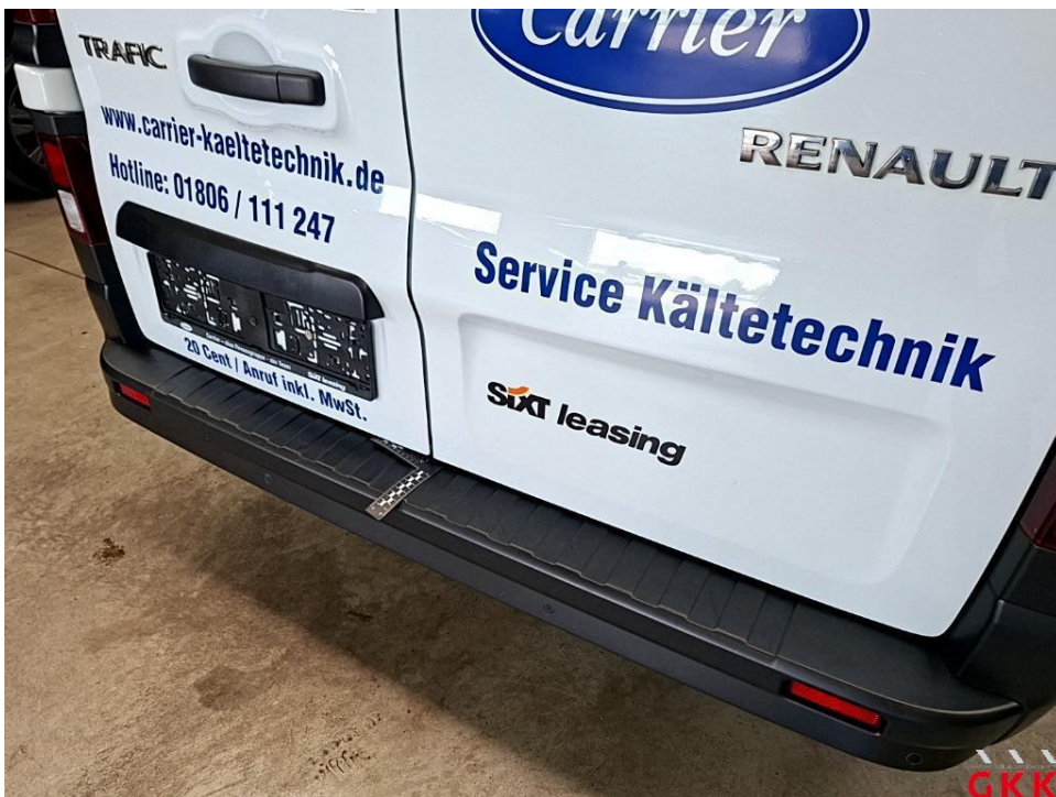
Bild 24. Stoßfänger hinten, Verkleidung -unlackiert-, verkratzt, Smartrepair
