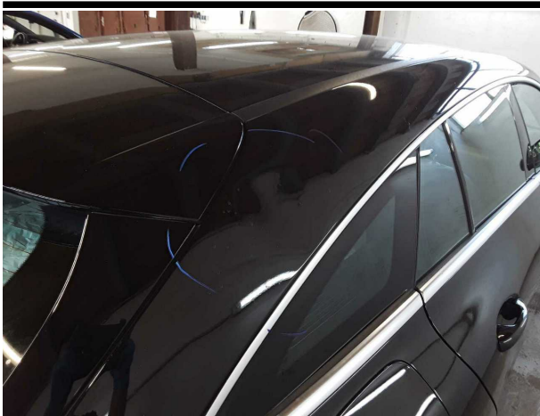
Beschädigung #6: Fahrzeugdach: Dachholm rechts - Delle(n) - instandsetzen und lackieren
