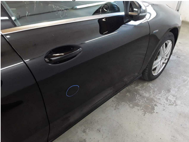
Beschädigung #3: Tür vorn rechts: Tür - Delle(n) - sanft instandsetzen
