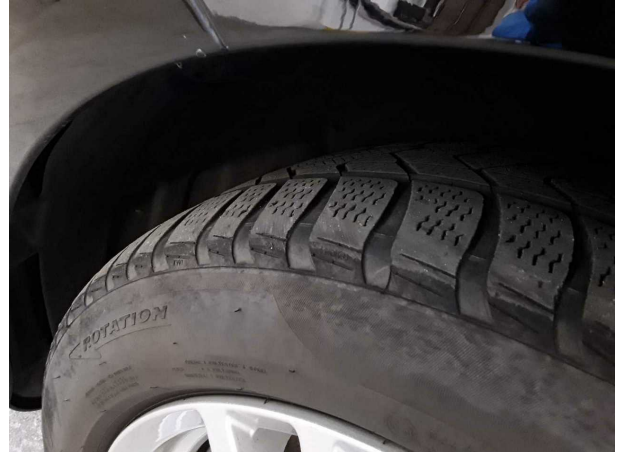
Beschädigung #2: Rad/Reifen: Reifen vorn (Außen abgefahren) - verschlissen - kein Abzug
