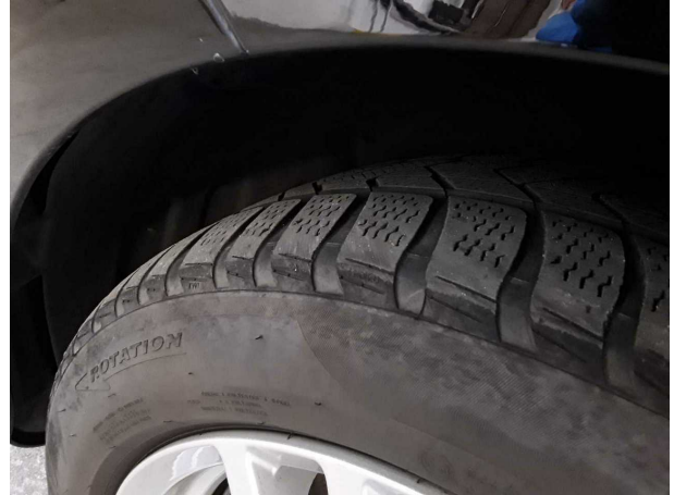
Damage #2: Wheel / tyres: Tyre - front (Außen abgefahren) - Worn - No deduction
