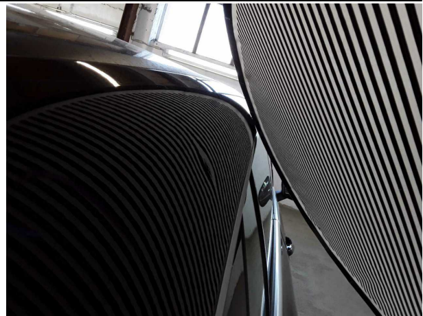
Beschädigung #6: Fahrzeugdach: Dachholm rechts - Delle(...) instandsetzen und lackieren
