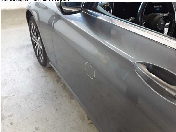
Beschädigung #7: Tür vorn links: Tür - Delle(n) - sanft instandsetzen
