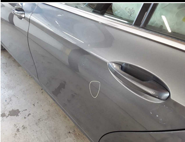
Beschädigung #4: Tür hinten links: Tür - Delle(n) - sanft instandsetzen
