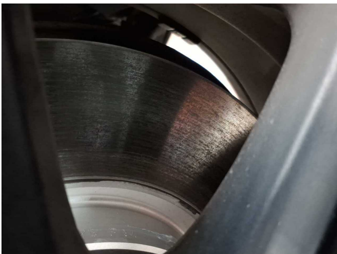
Damage 8: Braking system: Brake discs and brake pads - front (Tragbild nicht in Ordnung) - Replace
