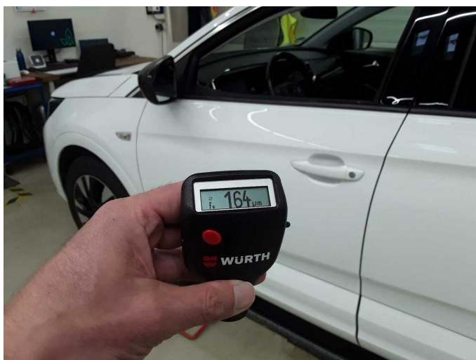
Door - front left side: 164 µm
