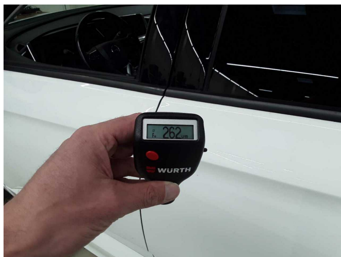
Door - rear left side: 262 µm
