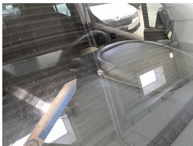
Damage 10: Vehicle glazing: Windscreen (kein Staubschutz) - Broken / torn - Replace
