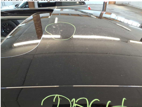
Beschädigung #9: Fahrzeugdach: Dach - Delle / Lackschaden - instandsetzen und lackieren
