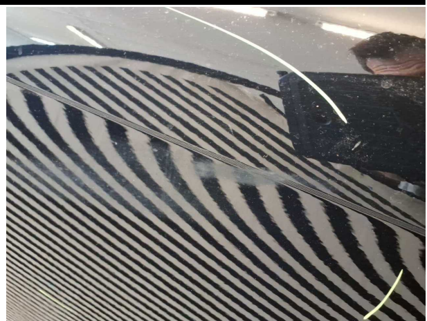
Beschädigung #7: Tür hinten rechts: Tür - Lackmangel - instandsetzen und lackieren
