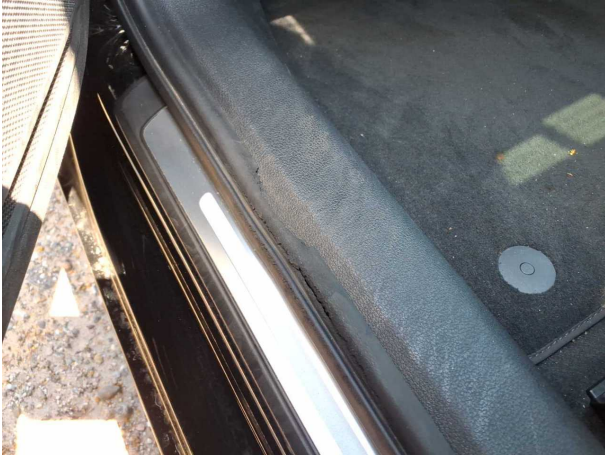
Beschädigung #4: Tür vorn links: Türdichtung - beschädigt - erneuern
