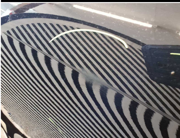
Beschädigung #7: Tür hinten rechts: Tür - Lackmangel - instandsetzen und lackieren
