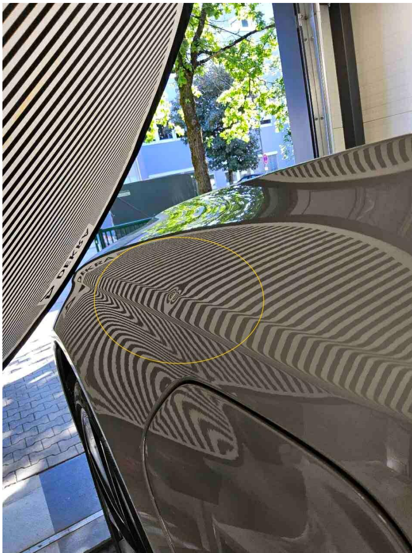
Bild 17 : Kotflügel links zerkratzt und deformiert
