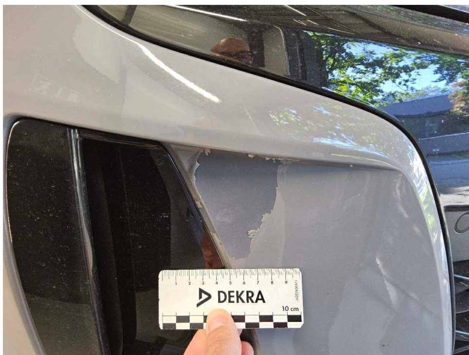
Bild 24 : Stoßfänger und Blende vorne rechts und gebrochen
