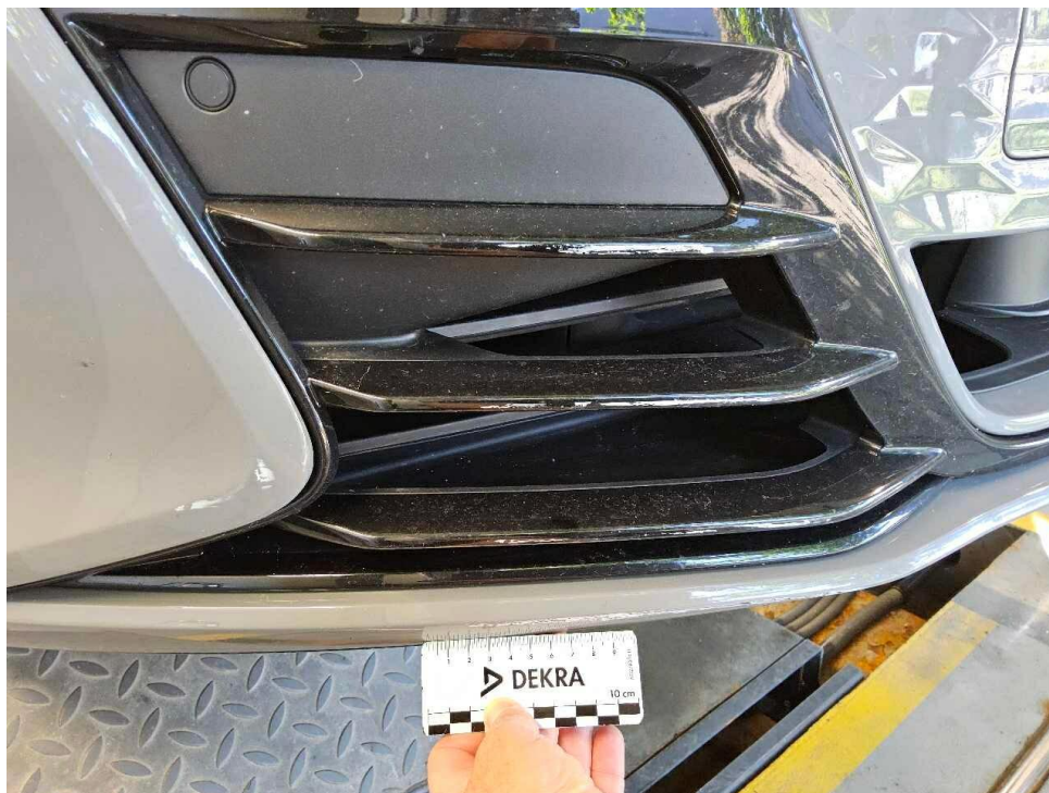
Bild 23 : Stoßfänger und Blende vorne rechts und gebrochen
