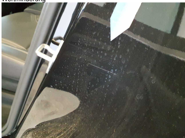
Beschädigung #3: Seitenwand links: Einstieg - Kratzer - Smart Repair
