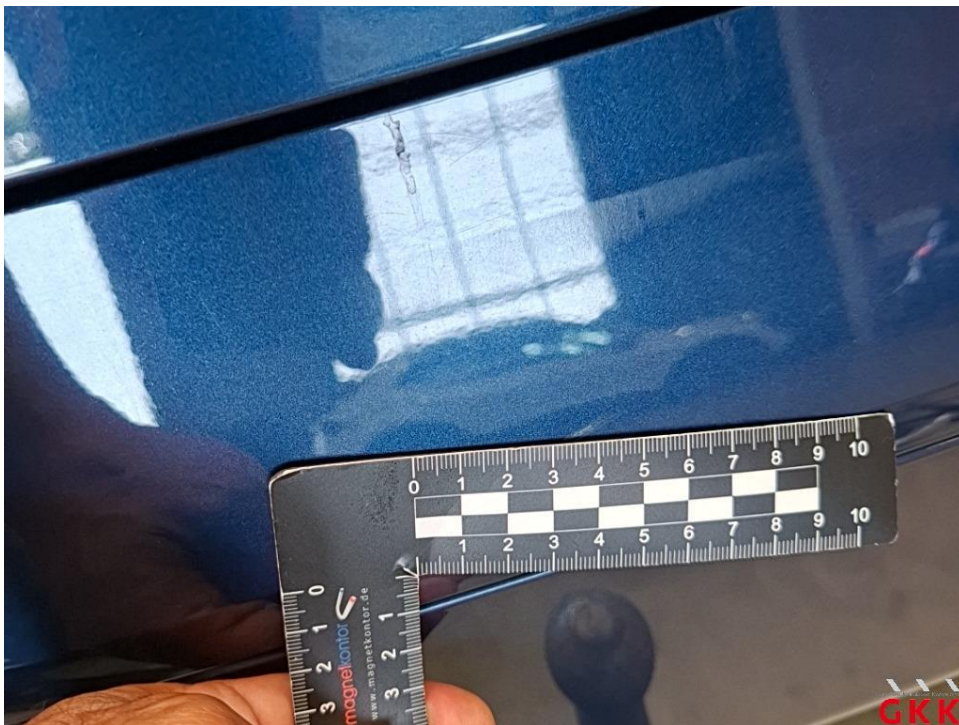
Bild 18. Stoßfänger hinten, Verkleidung -lackiert-, Lackiernebel, aufbereiten
