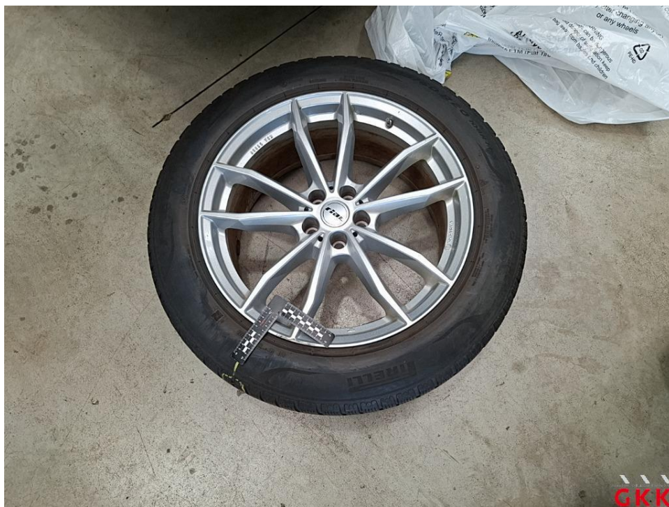
Bild 24. LM-Rad, 1 x beiliegend, Materialabtrag, ersetzen
