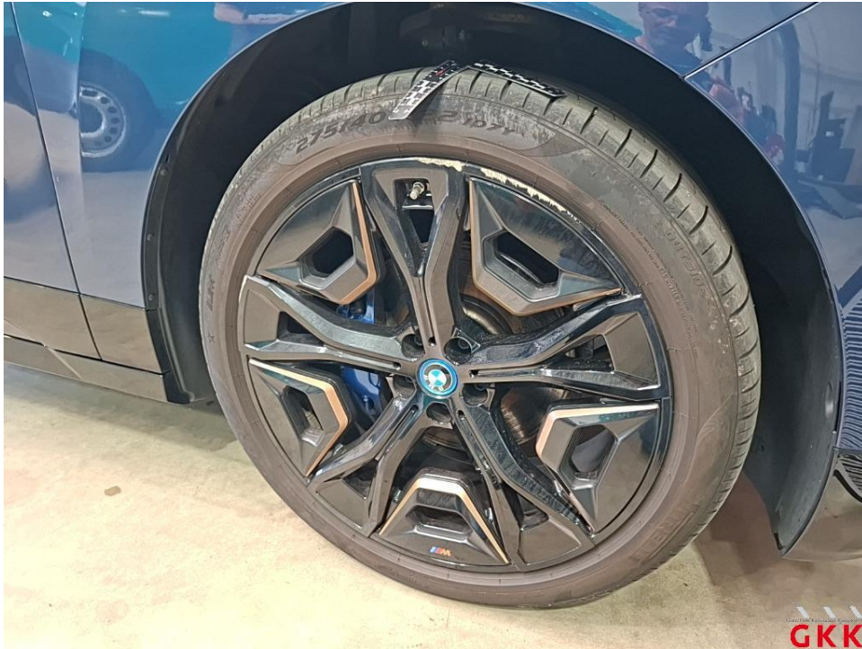
Bild 27. LM-Rad, vorne rechts, Materialabtrag, ersetzen
