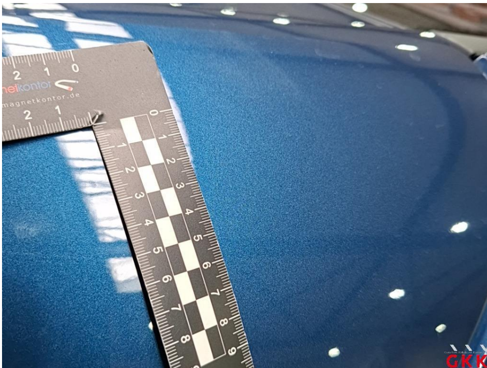
Bild 20. Heckklappe, Spoiler -lackiert-, Reparaturmangel, auslegen, schleifen, polieren
