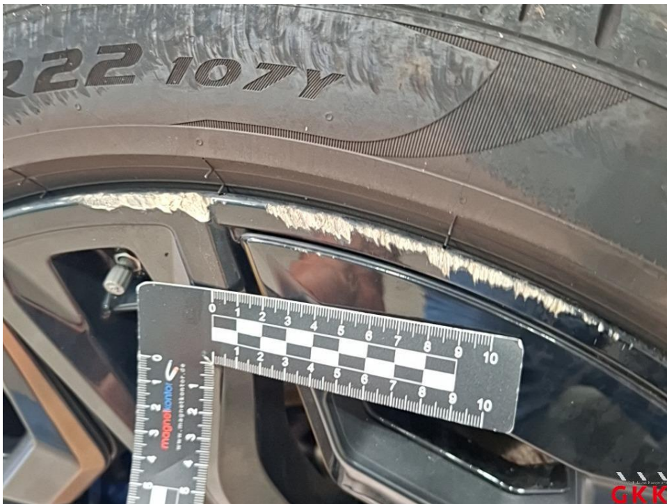
Bild 28. LM-Rad, vorne rechts, Materialabtrag, ersetzen
