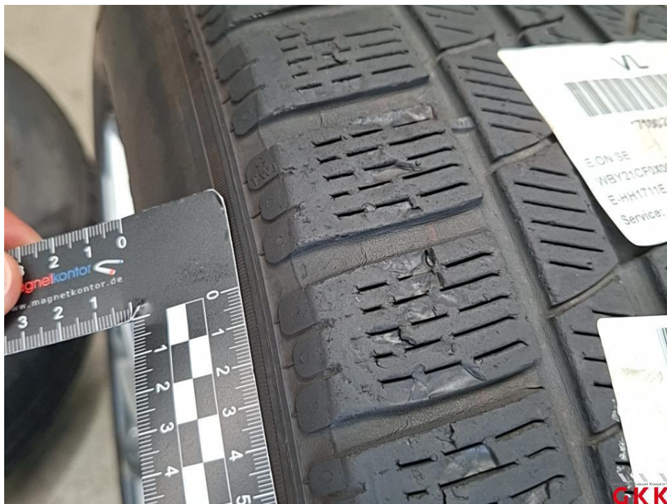
Bild 23. Reifen, 4 x beiliegend, beschädigt, ersetzen
