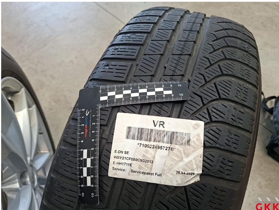
Bild 22. Reifen, 4 x beiliegend, beschädigt, ersetzen
