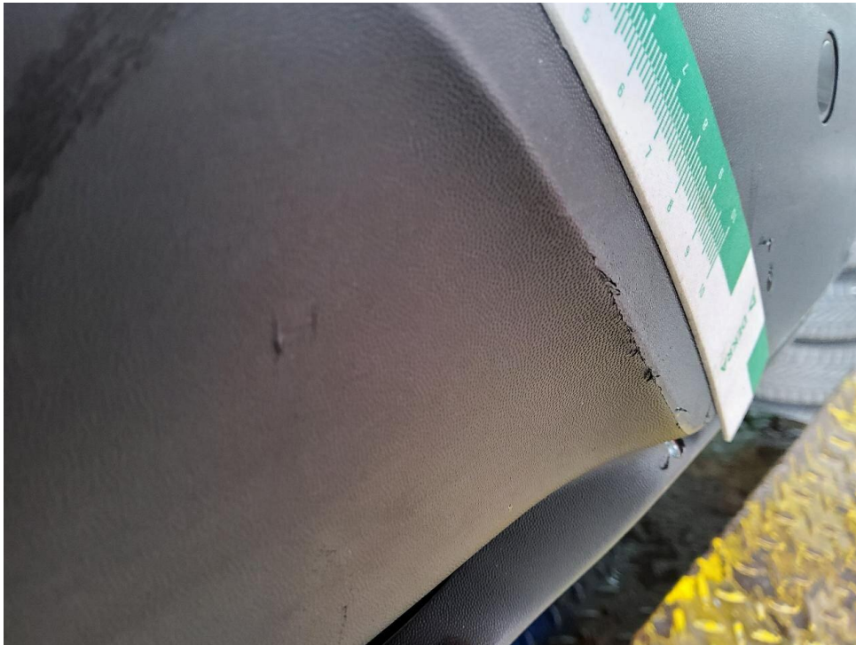
Bild 13 : Stoßfänger hinten Unterteil zerkratzt, im Verbund erneuern
