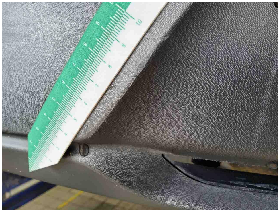
Bild 12 : Stoßfänger hinten Unterteil zerkratzt, im Verbund erneuern
