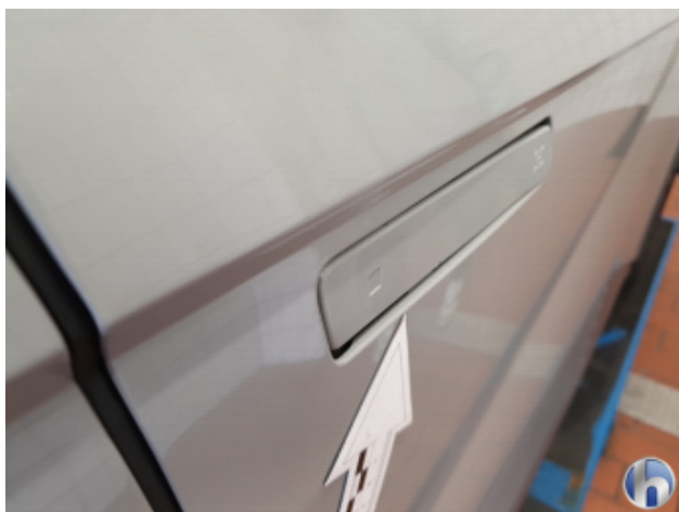
3. Außentürgriff Vorne - Rechts Nicht In Ordnung - Erneuern
