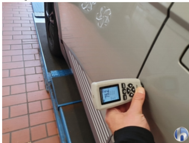
1. Tür Vorne - Rechts Nachlackiert - Instandsetzen und Lackieren
