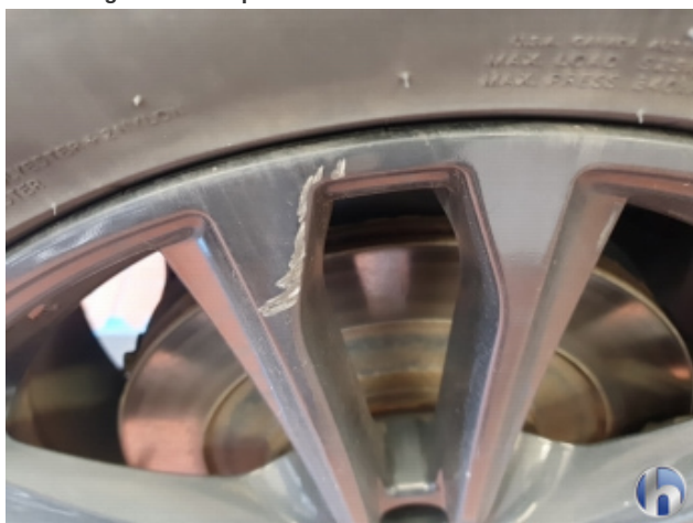
5. Felge Hinten - Rechts Beschädigt - Smart Repair
