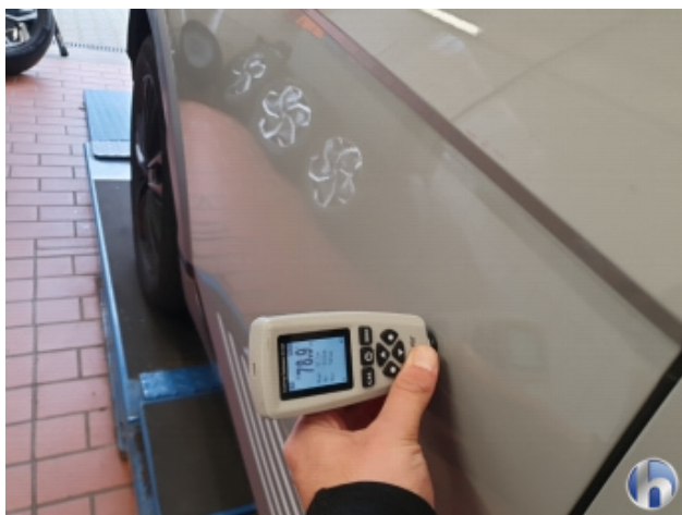
2. Tür Hinten - Rechts Nachlackiert - Instandsetzen und Lackieren
