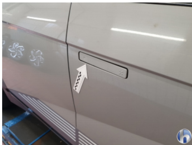
3. Außentürgriff Vorne - Rechts Nicht In Ordnung - Erneuern
